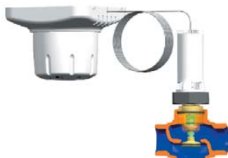
Температура помещения выше заданного значения, клапан открыт
