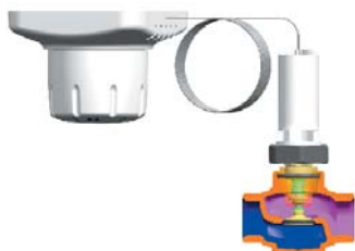
Температура помещения ниже заданного значения, клапан закрыт
