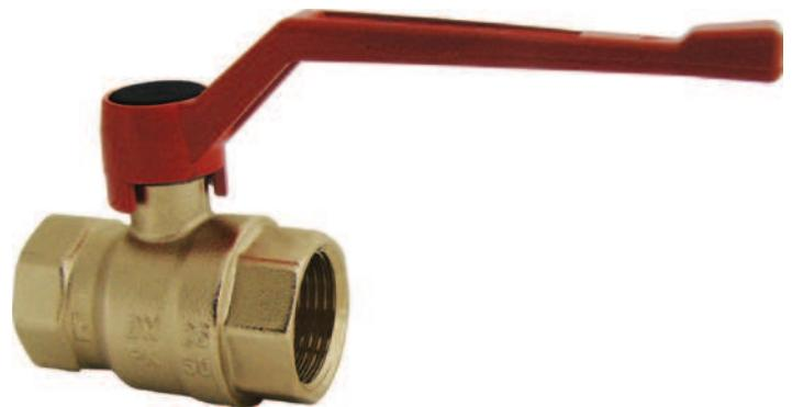
**ШАРОВОЙ КРАН ГЕРЦ МОДЕЛЬ 2216**, размеры DN 15 (1/2") до DN 50 (2"), номинальное давление 25 бар, вода, рекомендуются для сантехнических систем. Рукоятка рычажная или в форме крыла (бабочка). Подключение внутренней-наружной резьбой согласно ISO 7. Корпус из специальной латуни устойчивой к вымыванию цинка, без покрытия. Рукоятка красная.
