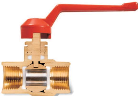
**ВАРИАНТ СО СЛИВОМ (2402)**, размеры DN 15 (1/2") до DN 40 (1 1/2"), номинальное давление от 25 до 40 бар в зависимости от размера, вода, рекомендуются для систем отопления. Рукоятка рычажная или в форме крыла (бабочка). Подключение с двух сторон внутренней резьбой согласно ISO 7. Латунный корпус никелирован, рукоятка красная.
