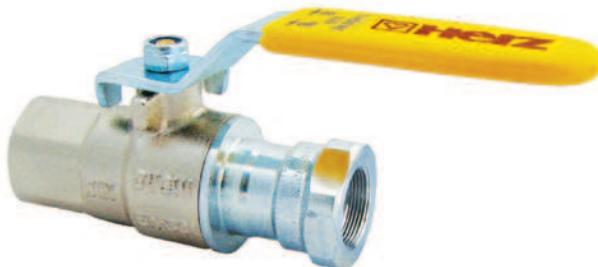
**ШАРОВОЙ КРАН ГЕРЦ МОДЕЛЬ 2300**, размеры DN 8 (1/4") до DN 50 (2"), номинальное давление PN 1 бар, для технического газа и систем газоснабжения согласно DIN DVGW G260 и ÖVGW. Рабочая температура от -20°C до +60°C. Рукоятка рычажная или в форме крыла (бабочки) из прокатной стали. Подключение с двух сторон внутренней резьбой согласно ISO 7. Латунный корпус без покрытия. Рукоятка нормативного жёлтого цвета.
