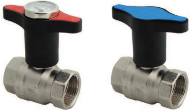
**ШАРОВОЙ КРАН ГЕРЦ МОДЕЛЬ 2206**, размеры DN 15 (1/2") до DN 50 (2"), номинальное давление 25 бар, вода, рекомендуются для сантехнических систем. Рукоятка рычажная или в форме крыла (бабочка). Подключение с двух сторон внутренней резьбой согласно ISO 7. Корпус из специальной латуни устойчивой к вымыванию цинка, без покрытия. Рукоятка красная.
