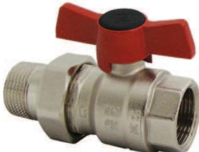
**ШАРОВОЙ КРАН ГЕРЦ МОДЕЛЬ 2201**, размеры DN 15 (1/2") до DN 50 (2"), номинальное давление 25 бар, вода, масло, рекомендуются для систем отопления. Рукоятка воротковой формы. Подключение с двух сторон внутренней резьбой согласно ISO 7. Латунный корпус никелирован, рукоятка черного цвета с синей или красной накладкой для модели с термометром.
