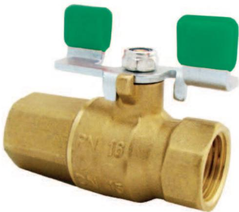
**ШАРОВОЙ КРАН ГЕРЦ МОДЕЛЬ (2304, 2305)**, размеры DN 10 (3/8") до DN 50 (2"), номинальное давление PN 4 бар, для технического газа и систем газоснабжения согласно DIN DVGW G260. Рабочая температура от -20°C до +60°C. Рукоятка рычажная или в форме крыла (бабочки) из прокатной стали. Подключение с двух сторон внутренней резьбой или с одной наружной резьбой согласно ISO 7. Латунный корпус никелирован. Рукоятка нормативного жёлтого цвета.
