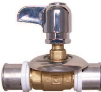
**ШАРОВОЙ КРАН ГЕРЦ МОДЕЛЬ 2100 W**, размеры DN 15 (1/2") до DN 50 (2"), номинальное давление PN 16 бар, вода. Рекомендуются для сантехнических систем. Проходной формы, с промываемым шаром без застойных зон – согласно директиве DVGW - во избежание роста числа Легионелл. Рукоятка рычажная или в форме крыла (бабочка). Подключение с двух сторон внутренней резьбой согласно ISO 7. Корпус из специальной латуни, устойчивой к вымыванию цинка, без покрытия, рукоятка зелёная.
