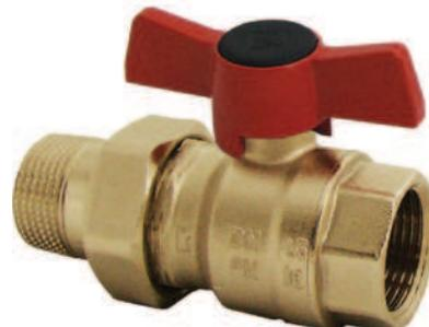
**ШАРОВОЙ КРАН ГЕРЦ МОДЕЛЬ 2206**, размеры DN 15 (1/2") до DN 50 (2"), номинальное давление PN 25 бар, вода, рекомендуются для сантехнических систем. Рукоятка воротковой формы. Подключение с двух сторон внутренней резьбой согласно ISO 7. Корпус из специальной латуни устойчивой к вымыванию цинка, без покрытия. Рукоятка черного цвета с красной или синей накладкой для модели с термометром.
