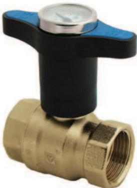
**ШАРОВОЙ КРАН ГЕРЦ МОДЕЛЬ 2100**, размеры DN 8 (1/4") до DN 80 (3"), номинальное давление от 16 до 63 бар в зависимости от размера, вода, масло, рекомендуются для систем отопления. Рукоятка рычажная или в форме крыла (бабочка). Подключение с двух сторон внутренней резьбой или внутренней-наружной резьбой согласно ISO 7. Латунный корпус никелирован, рукоятка красная.
