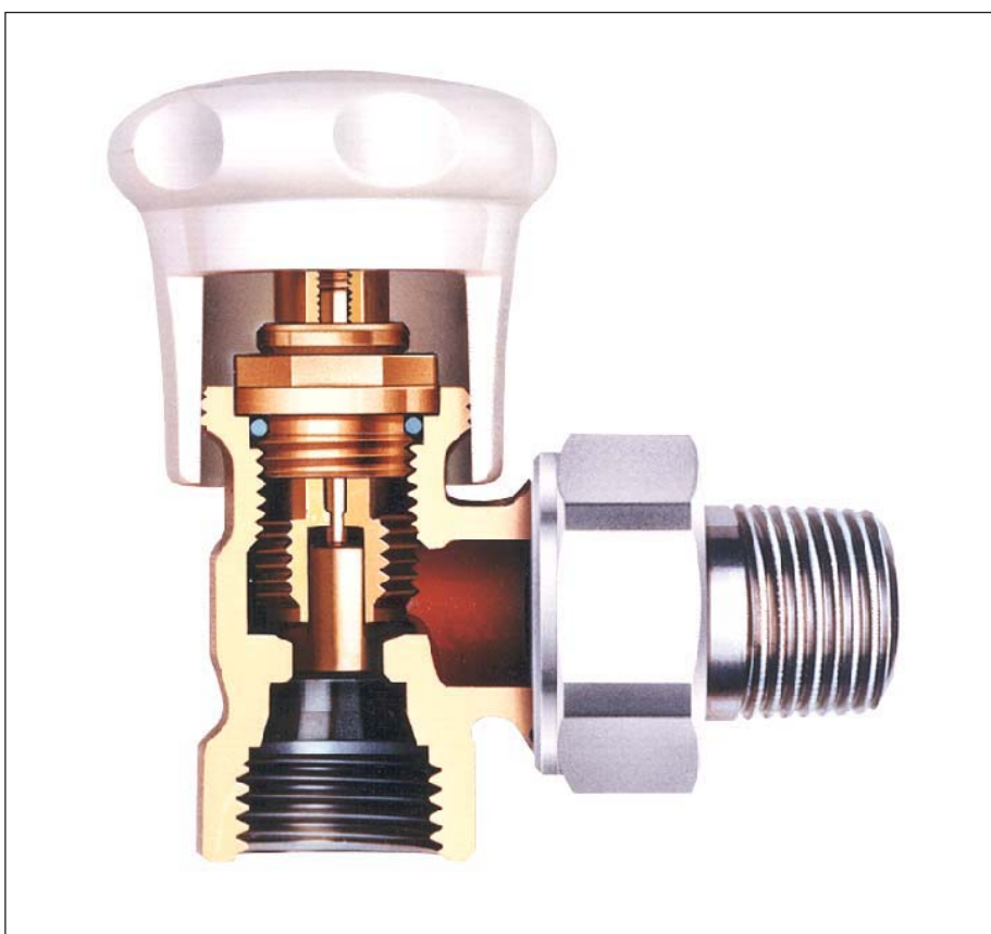
Рис. 11-5. Радиаторный вентиль ГЕРЦ-АС-Т-90 в разрезе
