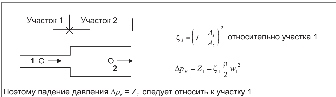
Рис. 1-5. Местное сопротивление - расширение трубы
