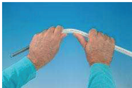
Гибка с помощью внутренней гибочной пружины
