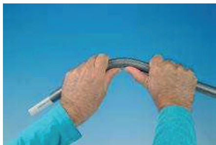
Гибка с помощью внешней гибочной пружины
