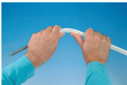
Гибка с помощью внутренней гибочной пружины
