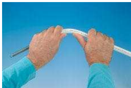
Гибка с помощью внутренней гибочной пружины
