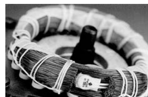
Рис. 23 Термовыключатель, встроенный в обмотку электродвигателя
