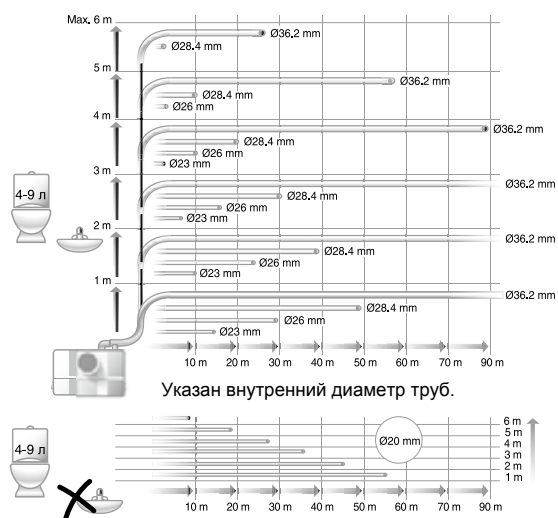
Рис. 55. Максимальная длина вертикальных и горизонтальных сливных труб
