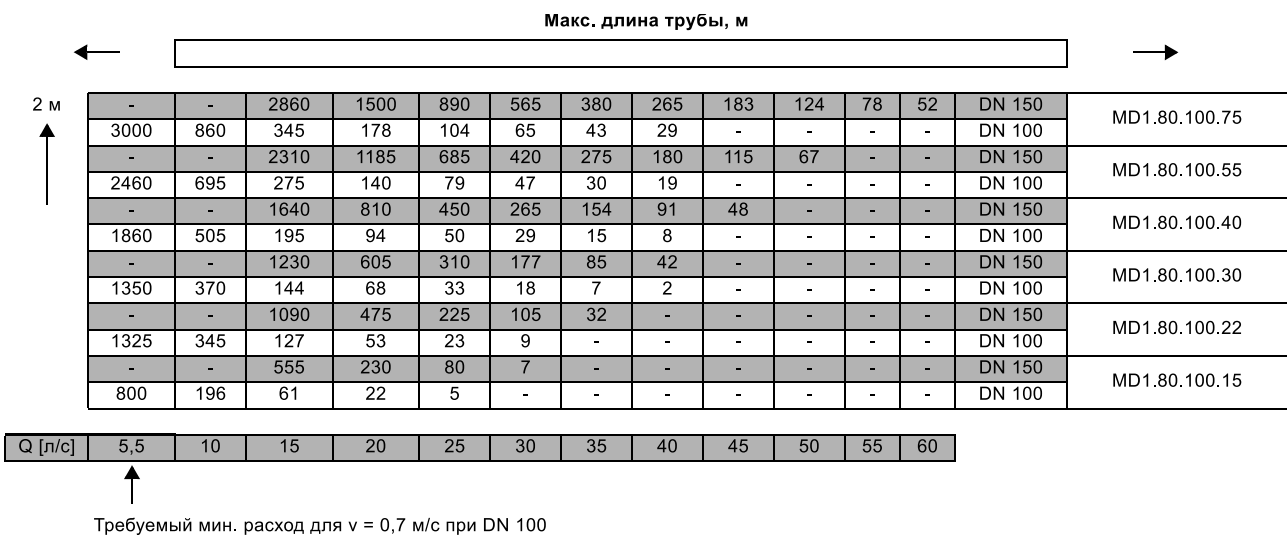
Рис. 111. Максимальная длина вертикальных или горизонтальных напорных трубопроводов
