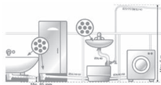
Рис. 52 Для раковины и душевой кабины (SOLOLIFT2 D-2)
