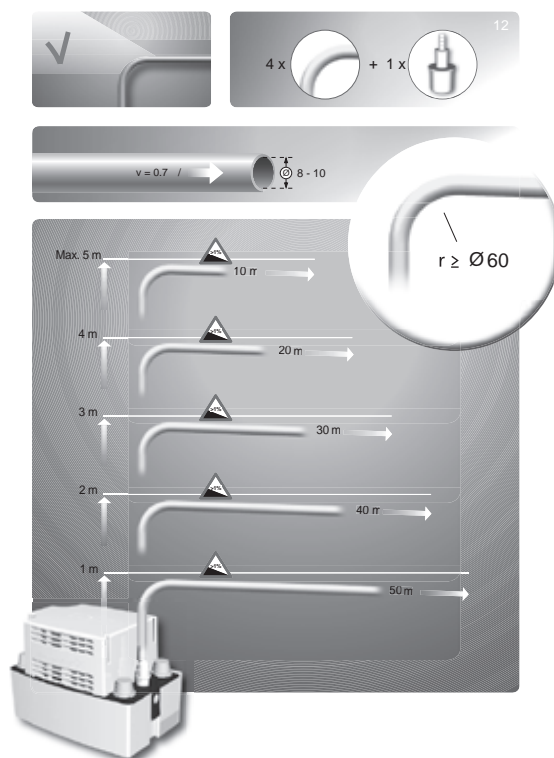
Рис. 71 Максимальная длина вертикального и горизонтального напорных шлангов
