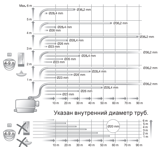
Рис. 58 Максимальная длина вертикальных и горизонтальных сливных труб
