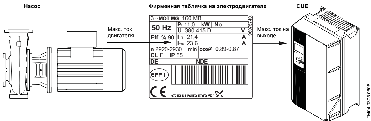
Рис. 48 Подбор CUE на основании максимального тока двигателя.
