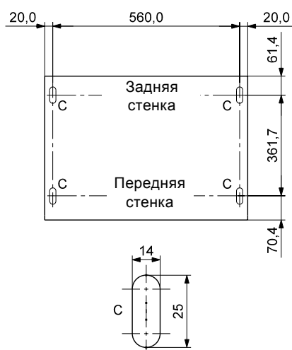
Рис. 59 Шаблон для сверления под подставку (мм)
