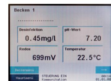
Информацию можно в любой момент посмотреть на сенсорной панели управления. Является дистанционным пультом управления и одновременно показывает все важные параметры воды, а также сетевые компоненты контрольно-измерительной станции GENO®-CPR-tronic 02 family и блока управления фильтровальной установки GENO®-BW-tronic.
