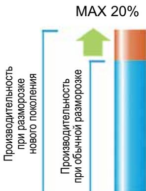
Скорость разморозки тесно связана с выходной мощностью компрессора. Обычная мультizonальная система в процессе разморозки ограничивает производительность компрессора, что приводит к увеличению длительности разморозки или различным нежелательным явлениям. Наружные блоки GMV X в процессе разморозки автоматически регулируют производительность в соответствии с определяемыми в режиме реального времени значениями параметров системы, обеспечивая тем самым надежную и быструю разморозку.
