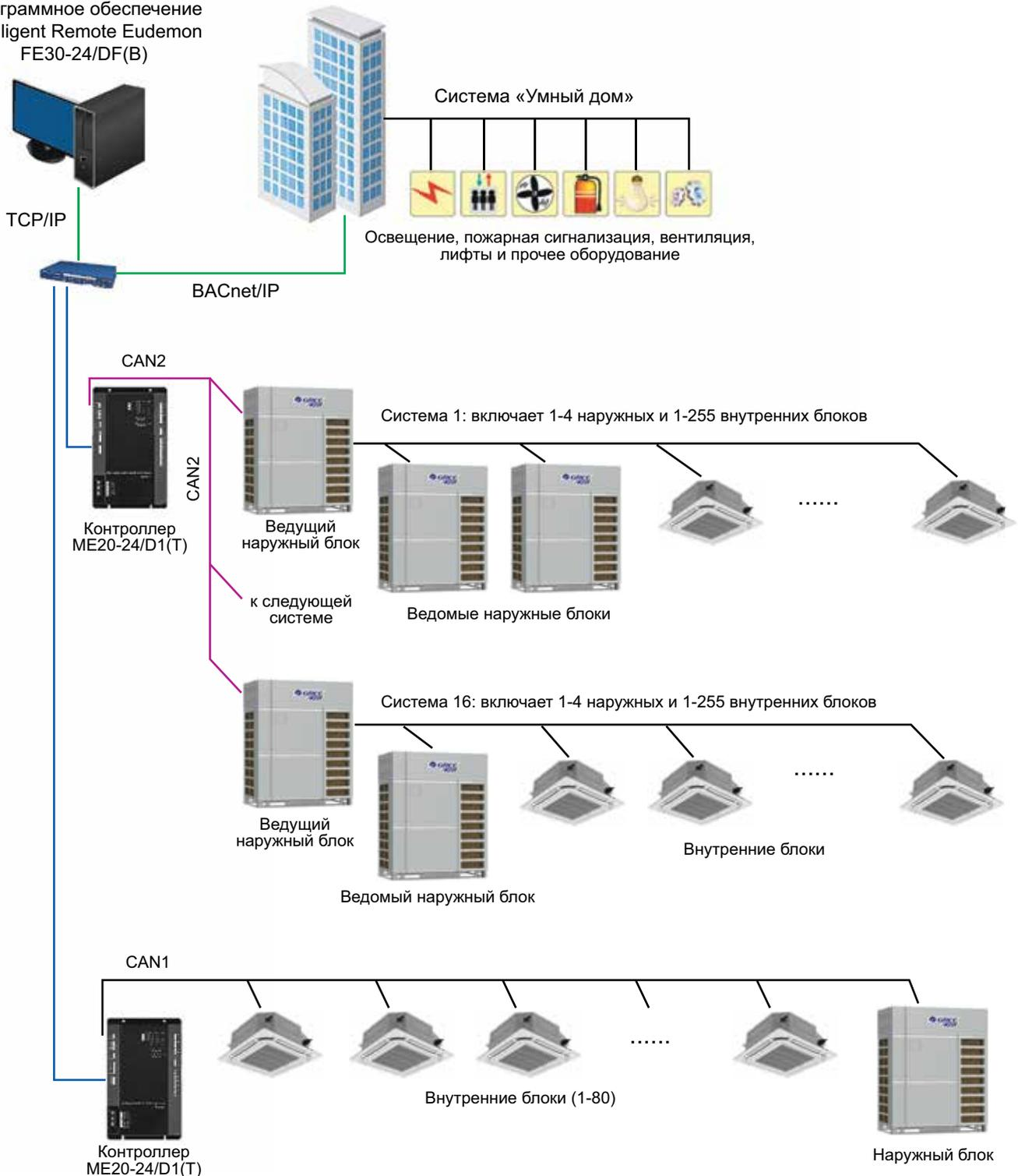
\* К одному контроллеру может быть подключено 16 мультизональных систем и 255 внутренних блоков
