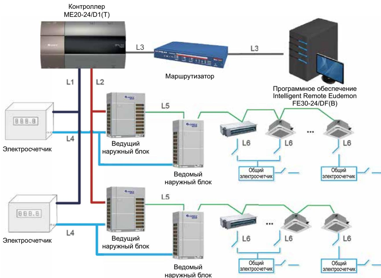
L1: Шина RS485 для связи между сетевым шлюзом и электросчетчиком
