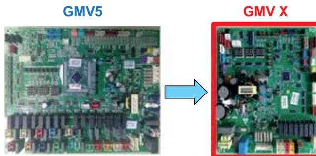
Благодаря интегрированной конструкции общий размер электрической коробки снизился на 35%, установка и обслуживание стали более удобными.
