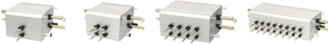
Распределительный блок — это устройство, которое осуществляет управление потоками хладагента в мультизональных системах GMV6 с рекуперацией тепла и позволяет запустить подключенные к нему внутренние блоки в любой режим независимо от того, в каком режиме работают другие внутренние блоки этой мультизональной системы.
