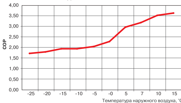
График изменения COP в зависимости от уличной температуры (при поддержании в помещении температуры 20 °С) для AGHG12LVCB
