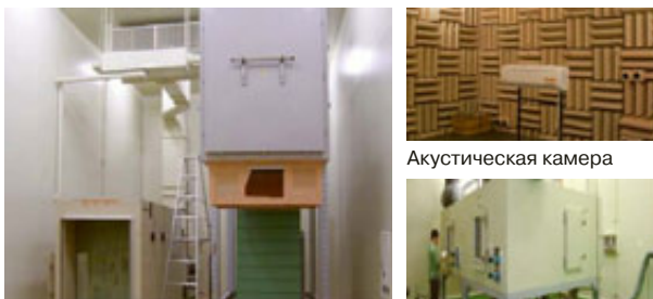
Камера для испытания показателей по расходу воздуха
