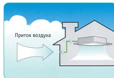
Подмес свежего воздуха с улицы (кроме compact)
