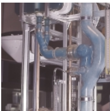
Стенд для гидроиспытаний
