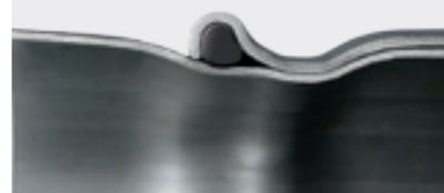
Равномерное обжатие уплотнительного кольца в ходе опрессовки.
