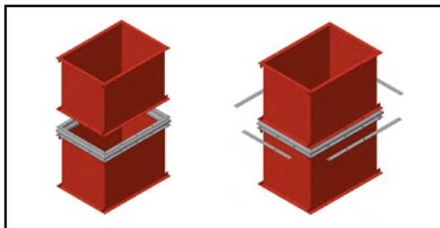
3. Поверх смонтированного между двумя воздуховодами компенсатора устанавливается огнезащитное полотно, производится протяжка ленточными хомутами по периметру смонтированной конструкции и фиксируется специальными зажимами.
