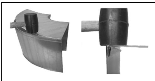
4. Выровняйте торцы собранного воздуховода так, чтобы они были в одной плоскости. Установите предварительно собранные фланцы на торцы воздуховода с двух сторон
