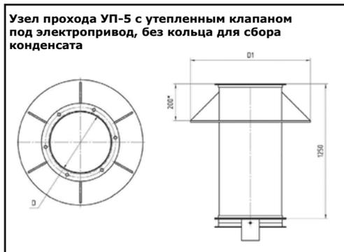
Узел прохода УП-5 с утепленным клапаном под электропривод
