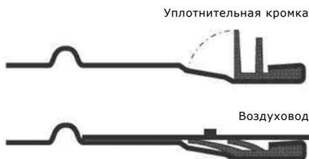
Используемая прокладка основана на гомогенной EPDM резине. Прокладка закреплена на конце фасонного элемента и тщательно зафиксирована по окружности завернутым краем фасонного элемента. Такое выполнение гарантирует, что прокладка всегда остается на своем месте, независимо от условий монтажа.
