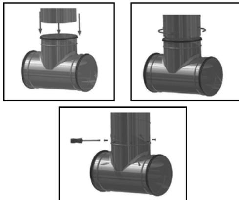
На показанном выше рисунке представлена монтажная схема с правильной последовательностью размещения винтов.
