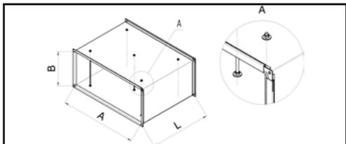
Установка угловых распорок производится по следующим критериям:
