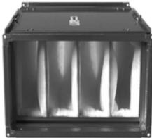
Во внутрь корпуса фильтра для прямоугольных каналов ФКПС устанавливается фильтр-кассета карманного типа. Фильтр-кассета вставляется в канал сверху и закрывается при помощи барашковых гаек. Данная конструкция фильтра ФКПС обеспечивает легкую замену фильтр-кассеты.
