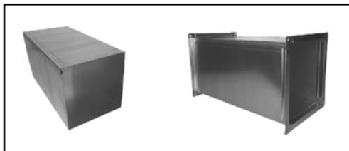
5. Прикрепите фланцы к изделию механически с помощью саморезов, вытяжных заклепок или специального инструмента с шагом не более 180 мм, но не менее двух пуклевок на сторону. Допускается увеличение количества пуклевок для повышения жесткости изделия
