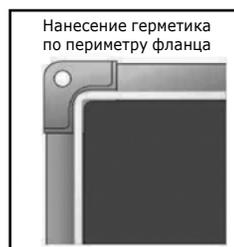
Угловое уплотнение важно, так как углы часто могут быть источником утечки. Вследствие различных значений длины стенок воздуховода (например, неаккуратные пальцы), может легко образоваться щель, которую невозможно ликвидировать с помощью уплотнительной прокладки воздуховода. Распределение герметика на основе мастики в углублениях угла может предупредить риск такой утечки.
