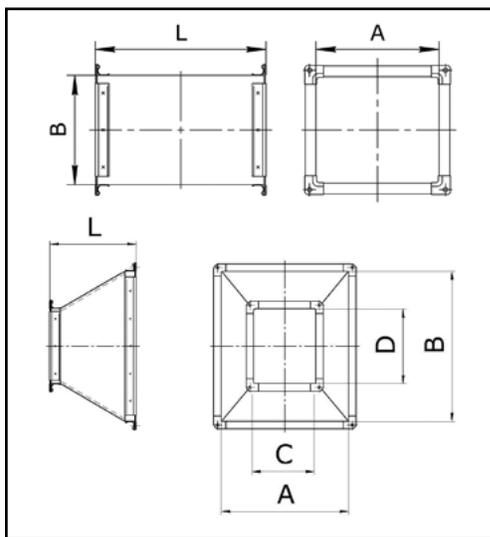
Допускаемые отклонения длин секций воздуховодов составляют IT16/2 по ГОСТ 25346-89
