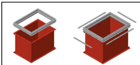
2. Соединить конструкцию с ответным воздуховодом и установить второй комплект прижимных фланцев. Сборку выполнять болтовым соединением
