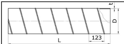
Воздуховоды спиральнонавивные диаметрами от Ø80 до Ø1250 мм в стандартном исполнении поставляются длиной  $L = 3\ 000$  мм. Воздуховоды спиральнонавивные диаметром Ø1400 мм поставляются длиной  $L = 2\ 000$  мм.
