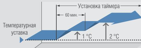
В режиме охлаждения температурная уставка автоматически повышается на 1 °С каждый час (но не более, чем на 2 °С).
