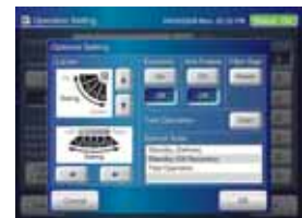
Мониторинг работы внутренних блоков
