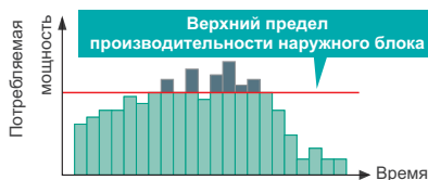
Окно регулирования производительности наружного блока
