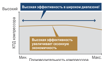
Двухроторный компрессор постоянного тока с высоким КПД в широком диапазоне мощностей
