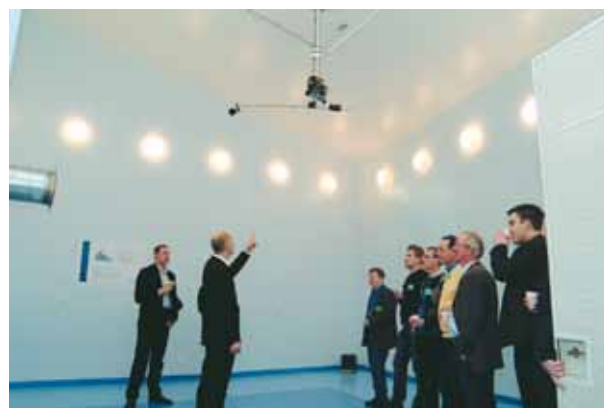
В акустической камере нет параллельных поверхностей, таким образом, исключается интерференция и резонанс звуковых колебаний. Чтобы исключить возможные вибрации почвы, в основании камеры установлены 76 пружин. Фоновый уровень шума составляет 9 дБ(А).
