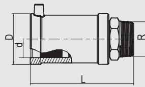
Компактное изделие. Часть ПЭ-ВП имеет открытый нагревательный элемент для оптимальной теплопередачи, большую глубину сопряжения, особо широкую зону сварки, а также холодную зону, предотвращающую вытекание расплавленной массы на торце и в области перехода, для сварки без позиционеров. Латунная часть неразъемная и надежно закреплена от прокручивания в ПЭ-ВП. Самоуплотняющаяся запатентованная геометрия уплотнения без эластомерного уплотнения. Для применения в области водоснабжения.
