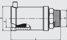
Компактное изделие. Часть ПЭ-ВП имеет открытый нагревательный элемент для оптимальной теплопередачи, большую глубину сопряжения, особо широкую зону сварки, а также холодную зону, предотвращающую вытекание расплавленной массы на торце и в области перехода, для сварки без позиционеров. Стальная часть неразъемная и надежно закреплена от прокручивания в ПЭ-ВП. Самоуплотняющаяся запатентованная геометрия уплотнения без эластомерного уплотнения. Для применения в области газоснабжения.
