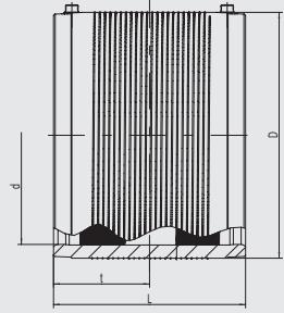
Открытая нагревательная спираль для оптимальной теплопередачи во время сварки, большая глубина сопряжения, очень широкие зоны сварки и холодные зоны на концах и в середине для предотвращения вытекания расплава и для использования без применения позиционеров. С индикаторами зон сварки.
