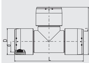
Имеют открытую нагревательную спираль для оптимальной теплопередачи на всех 3 выходах, большую глубину сопряжения, особо широкую зону сварки, холодные зоны по бокам и в центре, предотвращающие вытекание расплавленной массы, не требуют при работе специальных позиционеров и приспособлений. Раздельные зоны сварки. Разгрузка на строительной площадке производится легко благодаря приваренным болтам с проушиной.
