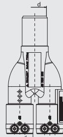
Разветвитель для труб (Y-вилка) в компактном исполнении с двумя электросварными зонами и ПЭ-патрубком спигот на конце для соединения труб, например через отвод FRIALEN 90°.
