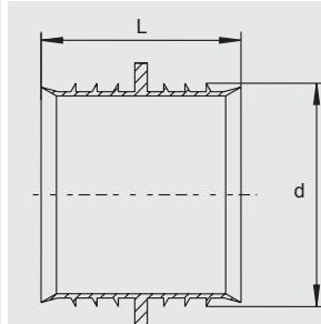
Для ремонта в безнапорном состоянии домовых вводов водопроводов. Предотвращает попадание воды в сварную зону FRIALEN - муфт типа MB и UB.
