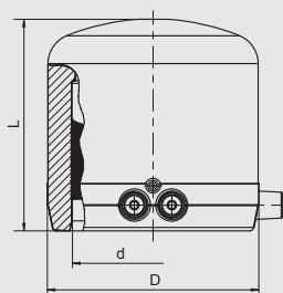
Имеет открытую нагревательную спираль для оптимальной теплопередачи, большую глубину сопряжения, особо широкую зону сварки, холодную зону на торце, предотвращающую вытекание расплавленной массы. С индикаторами зон сварки.
