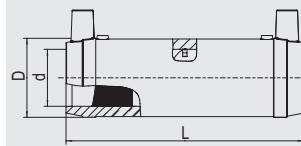
Муфты, имеющие много плюсов в отношении безопасности. Имеют открытую нагревательную спираль для оптимальной теплопередачи, особо большую глубину сопряжения, особо широкую зону сварки, особо большие холодные зоны по бокам и в центре, обеспечивают оптимальное сопряжение с трубами с изогнутыми концами (из бухт), не требуют при работе специальных позиционеров и приспособлений. С индикаторами зон сварки.
