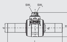
Компактное изделие из ПЭ-ВП, привариваемое в процессе монтажа FRIALEN - муфтами MB или UB. Не требуется мероприятий по защите от коррозии. Открытое и закрытое положения определяются упорами. Запорный кран, не требующий технического обслуживания, управляемый с помощью штанги (например FRIALEN - BS). Сертифицировано DVGW, Per.-Nr. DG-8631AU2251, DG-8631AU2252 и DG-8631AU2253.
