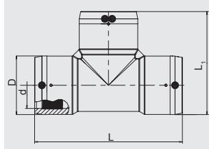
Имеют открытую нагревательную спираль для оптимальной теплопередачи на всех 3 выходах, большую глубину сопряжения, особо широкую зону сварки, холодные зоны по бокам и в центре, предотвращающие вытекание расплавленной массы, не требуют при работе специальных позиционеров и приспособлений. Прямоточная сторона сваривается за один раз, вследствие этого необходимы только 2 сварки.
