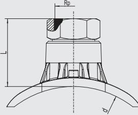
Используется для установки на всех диаметрах труб в заданной области с помощью прижимного приспособления FRIALEN FRIATOP (см. прайс-лист на приборы и технику FRIATOOLS). Компактное изделие. Представляет собой седловину из ПЭ-ВП с открытым нагревательным элементом для оптимальной теплопередачи. Переход ПЭ-ВП/красное литье является неразъемным и надежно закреплен в ПЭ-ВП от проворачивания. Служит для присоединения обычных латунных вентилей.
