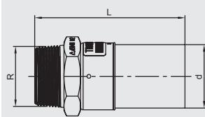
Компактное изделие. Полиэтиленовая часть дает возможность производить монтаж вне зависимости от положения и обеспечивает герметичное сварное соединение со всеми подходящими фасонными изделиями FRIALEN. Латунная часть неразъемна и надежно соединена с полиэтиленовой без возможности проворачивания.
