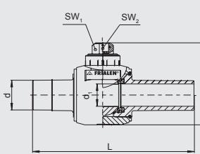
Компактное изделие из ПЭ-ВП, привариваемое в процессе монтажа FRIALEN - муфтами MB или UB. Проходное сечение крана соответствует внутреннему диаметру трубы. Не требуется мероприятий по защите от коррозии. Открытое и закрытое положения определяются упорами. Запорный кран, не требующий технического обслуживания, управляемый с помощью штанги (например FRIALEN - BS). Сертифицировано DVGW, Per.-Nr. DG-8631AU2251, DG-8631AU2252
