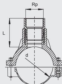
Компактное изделие. Представляет собой седловину из ПЭ-ВП с открытым нагревательным элементом для оптимальной теплопередачи. Переход ПЭ-ВП/красное литье является неразъемным и надежно закреплен в ПЭ-ВП от проворачивания. Служит для присоединения обычных латунных вентилей.
