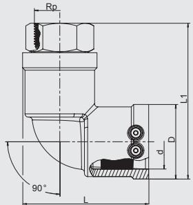
Компактное изделие. Часть ПЭ-ВП имеет открытый нагревательный элемент для оптимальной теплопередачи, большую глубину сопряжения, особо широкую зону сварки, а также холодную зону, предотвращающую вытекание расплавленной массы на торце и в области перехода, для сварки без позиционеров. Стальная часть неразъемная и надежно закреплена от прокручивания в ПЭ-ВП. Самоуплотняющаяся запатентованная геометрия уплотнения без эластомерного уплотнения. Для применения в области газоснабжения.
