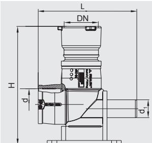
Для присоединения гидранта, имеющего на конце байонетное крепление типа BAIO, как альтернатива фланцевому соединению. Компактная деталь, состоящая из отвода FRIALEN 90° с под пятником (сравните с WF 90°) и байонетной муфты типа BAIO из ковкого чугуна с уплотнением. Литая муфта BAIO закреплена в полиэтилене неразъемно и неподвижно. Просьба следовать инструкции по монтажу для соединительной системы "BAIO". Для подземного гидранта необходима защита насадок BAIO от грязи и скручивания.
