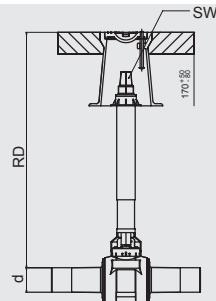
Телескопическая приводная штанга для управления кранами FRI-ALLEN - KH, KHP, AKHP и AKHP-TL через ковер. В заданной области (RD) бесступенчатая установка по высоте, также в смонтированном состоянии. Самофиксирующийся при любом положении вытяжения. Устойчив к коррозии. Исполнение со шпинделем 14 – специально для домовых подключений.
