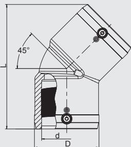
Имеют открытую нагревательную спираль для оптимальной теплопередачи, большую глубину сопряжения, особо широкую зону сварки, холодные зоны по бокам и в центре, предотвращающие вытекание расплавленной массы, не требуют при работе специальных позиционеров и приспособлений.
