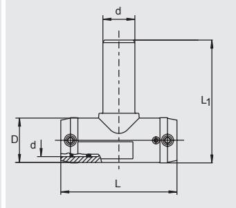
Прямой проход имеет открытую нагревательную спираль для оптимальной теплопередачи, большую глубину сопряжения, особо широкую зону сварки, а также предотвращающие вытекание расплавленной массы холодные зоны сварки на торцах и в середине для сварки без позиционеров. Удлиненный отводной патрубок рассчитан на 2 сварки.
