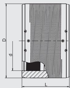
Имеет открытую нагревательную спираль для оптимальной теплопередачи, большую глубину сопряжения, особо широкую зону сварки, холодные зоны по бокам и в центре, предотвращающие вытекание расплавленной массы, не требуют при работе специальных держателей и приспособлений. С раздельными зонами сварки и индикаторами для каждой зоны.
