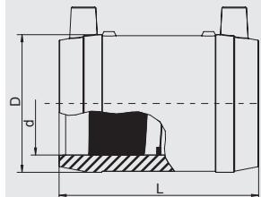
Применяются также в качестве ремонтных муфт. Имеют открытую нагревательную спираль для оптимальной теплопередачи, большую глубину сопряжения, особо широкую зону сварки, холодные зоны по бокам и в центре, предотвращающие вытекание расплавленной массы, не требуют при работе специальных позиционеров и приспособлений. С индикаторами зон сварки.
