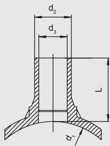
Для адаптации к трубам всех диаметров в заданной области с помощью прижимного приспособления FRIALEN FRIATOP (см. прайс-лист на приборы и технику FRIATOOLS). Компактное изделие седловой формы из ПЭ-ВП с открытым нагревательным элементом для оптимальной теплопередачи и выходным патрубком для FRIALEN - муфт типа MB или UB. Врезка без стружки в безнапорном состоянии с использованием обычных для этих целей приспособлений.
