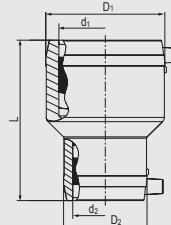
Имеют открытую нагревательную спираль для оптимальной теплопередачи, большую глубину сопряжения, особо широкую зону сварки, холодные зоны по бокам и в центре, предотвращающие вытекание расплавленной массы, не требуют при работе специальных позиционеров и приспособлений.
