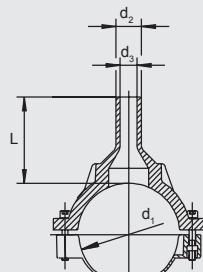
Компактное изделие из ПЭ-ВП, седловина с открытым нагревательным элементом для оптимальной теплопередачи и выходным патрубком для монтажа вместе с FRIALEN - муфтами типа MB или UB. Врезка выполняется в безнапорном состоянии с помощью подходящего приспособления для врезки.
