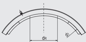
Компактное изделие из ПЭ-ВП для ремонта таких повреждений, как царапины, канавки или проникновения трубы. Накладка с открытой нагревательной спиралью для оптимальной теплопередачи. Для монтажа с помощью монтажного приспособления VACUSET XL (см. прайс-лист на приборы и технику FRIATOOLS). С индикатором зоны сварки.
