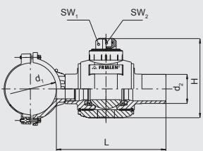
Компактное изделие из ПЭ-ВП. Это комбинация из FRIALEN - седловины и FRIALEN - шарового крана для экономящего место и стоимость горизонтального монтажа, специально для врезки трубопроводов-отводов в основную линию под давлением. Служит для врезки в действующие трубопроводы с давлением до 10 бар (газ) и 16 бар (вода) с помощью приспособления для врезки. Имеет открытый нагревательный элемент для оптимальной теплопередачи.
