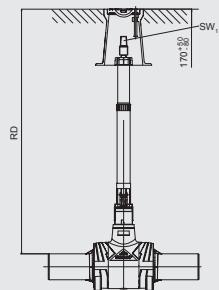
Телескопическая приводная штанга для управления FRIALOC – запорной арматуры из ПЭ через ковер. Оптимально подогнаны друг к другу. В заданной области (RD) бесступенчатая установка по высоте. Простой монтаж посредством применения фиксирующей защелки. Исполнение – из оцинкованной или нержавеющей стали.
