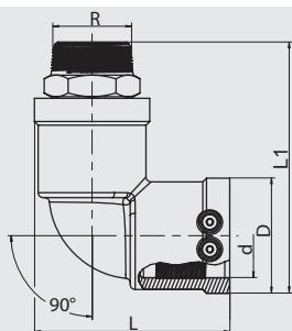
Компактное изделие. Часть ПЭ-ВП имеет открытый нагревательный элемент для оптимальной теплопередачи, большую глубину сопряжения, особо широкую зону сварки, а также холодную зону, предотвращающую вытекание расплавленной массы на торце и в области перехода, для сварки без позиционеров. Стальная часть неразъемная и надежно закреплена от прокручивания в ПЭ-ВП. Самоуплотняющаяся запатентованная геометрия уплотнения без эластомерного уплотнения. Для применения в области газоснабжения.
