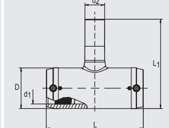
Имеют открытую нагревательную спираль для оптимальной теплопередачи, большую глубину сопряжения, особо широкую зону сварки, холодные зоны по бокам и в центре, предотвращающие вытекание расплавленной массы, не требуют при работе специальных позиционеров и приспособлений. Отводные патрубки SDR11 для приварки муфтами UB/MB.
