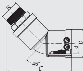
Компактное изделие. Часть ПЭ-ВП имеет открытый нагревательный элемент для оптимальной теплопередачи, большую глубину сопряжения, особо широкую зону сварки, а также холодную зону, предотвращающую вытекание расплавленной массы на торце и в области перехода, для сварки без позиционеров. Латунная часть неразъемная и надежно закреплена от прокручивания в ПЭ-ВП. Самоуплотняющаяся запатентованная геометрия уплотнения без эластомерного уплотнения. Для применения в области водоснабжения.
