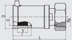
Компактное изделие. Часть ПЭ-ВП имеет открытый нагревательный элемент для оптимальной теплопередачи, большую глубину сопряжения, особо широкую зону сварки, а также холодную зону, предотвращающую вытекание расплавленной массы на торце и в области перехода, для сварки без позиционеров. Латунная часть неразъемная и надежно закреплена в ПЭ-ВП, с накидной гайкой для простого и быстрого монтажа на наружной резьбе закрепленной трубы. Уплотнительная прокладка в комплекте.
