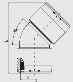
Имеют открытую нагревательную спираль для оптимальной теплопередачи, большую глубину сопряжения, особо широкую зону сварки, холодные зоны по бокам и в центре, предотвращающие вытекание расплавленной массы, не требуют при работе специальных позиционеров и приспособлений. Раздельные зоны сварки. Разгрузка на строительной площадке производится легко благодаря приваренным болтам с проушиной.
