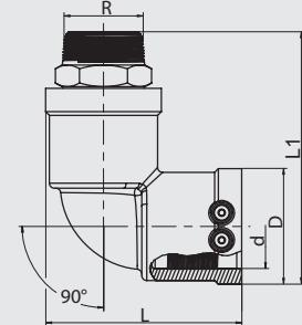
Компактное изделие. Часть ПЭ-ВП имеет открытый нагревательный элемент для оптимальной теплопередачи, большую глубину сопряжения, особо широкую зону сварки, а также холодную зону, предотвращающую вытекание расплавленной массы на торце и в области перехода, для сварки без позиционеров. Латунная часть неразъемная и надежно закреплена от прокручивания в ПЭ-ВП. Самоуплотняющаяся запатентованная геометрия уплотнения без эластомерного уплотнения. Для применения в области водоснабжения.
