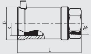
Компактное изделие. Часть ПЭ-ВП имеет открытый нагревательный элемент для оптимальной теплопередачи, большую глубину сопряжения, особо широкую зону сварки, а также холодную зону, предотвращающую вытекание расплавленной массы на торце и в области перехода, для сварки без позиционеров. Стальная часть неразъемная и надежно закреплена от прокручивания в ПЭ-ВП. Самоуплотняющаяся запатентованная геометрия уплотнения без эластомерного уплотнения. Для применения в области газоснабжения.
