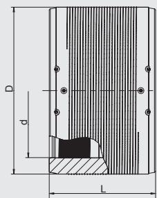
С открытой нагревательной спиралью для оптимальной передачи тепла, большая глубина вставки, широкие сварные зоны, широкие холодные зоны на концах и в середине для удержания давления расплава, монтаж возможен без дополнительных устройств. С индикаторами зон сварки. Сварка в диапазоне SDR 11 - SDR 7,4.
