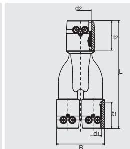
Разветвитель для труб (Y-вилка) в компактном исполнении с тремя электросварными зонами с открытыми нагревательными элементами для оптимальной передачи тепла на трубу.
