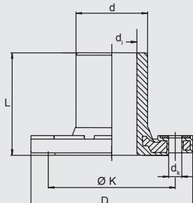
Ввариваемый бурт и фланец представляют собой цельное фланцевое изделие. Металлическая вставка во фланце для предотвращения явлений холодной текучести. Привариваемая часть пригодна для работы с FRIALEN - муфтами типа MB и UB. Размеры фланца согласно DIN 2501, часть 1. Рекомендуются уплотнения GST.
