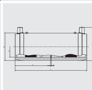
Муфты с повышенным удобством и надежностью при монтаже труб в бухтах. Имеют открытую нагревательную спираль для оптимальной теплопередачи, особо большую глубину сопряжения, особо широкую зону сварки, особо большие холодные зоны по бокам, обеспечивают оптимальное сопряжение с трубами с изогнутыми концами (из бухт), упрощает выравнивание несоосности труб.
