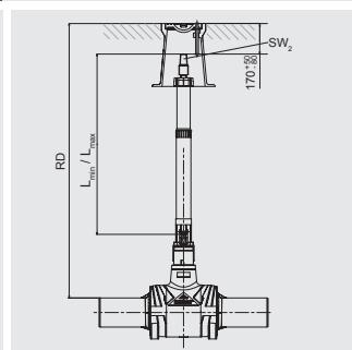
Телескопическая приводная штанга для управления запорной арматурой из ПЭ FRIALOC при использовании с ковером. Оптимально подходят друг к другу. В заданной области (RD) бесступенчатая установка по высоте. Простой монтаж посредством применения фиксирующей защелки. Исполнение - из оцинкованной или нержавеющей стали.
