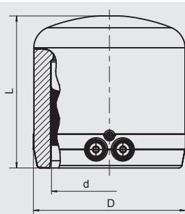
Имеют открытую нагревательную спираль для оптимальной теплоотдачи, большую глубину сопряжения, особо широкую зону сварки, а также предотвращающую выпадение расплавленной массы холодную зону на торце.
