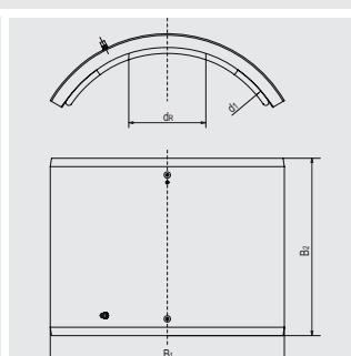
Компактное изделие из ПЭ-НД для ремонта таких повреждений, как царапины, борозды или трубы. Накладка с открытой нагревательной спиралью для оптимальной теплопередачи. Для монтажа при помощи вакуумного насоса FRIATOOLS (арт. 613827) и соответствующей герметизирующей колбы FRIATOOLS (см. раздел FRIATOOLS). Повреждение должно находиться внутри заданной для ремонта поверхности  $d_R$  и не должно перекрываться зоной сварки.
