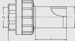
Компактное изделие. Полиэтиленовая часть дает возможность производить монтаж вне зависимости от положения и обеспечивает герметичное сварное соединение со всеми подходящими фасонными изделиями FRIALEN. Латунная часть часть неразъемная и надежно закреплена от прокручивания в ПЭ-НД.
