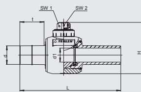
Компактное изделие из ПЭ-НД, привариваемое в процессе монтажамуфтами FRIALEN MB или UB. Проход крана соответствует внутреннему диаметру трубы. Не требуется мероприятий по защите от коррозии. Открытое и закрытое положения определяются упорами. Шаровый кран, не требующий технического обслуживания, управляемый с помощью монтажного набора (FRIALEN - BS).
