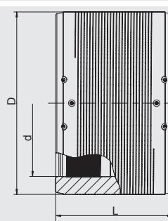
Имеет открытую нагревательную спираль для оптимальной теплопередачи, большая глубина вставки, широкие сварные зоны, широкие холодные зоны по бокам и в центре, предотвращающие вытекание расплавленной массы, упрощает выравнивание несоосности труб. С раздельными зонами сварки и индикаторами для каждой зоны.
