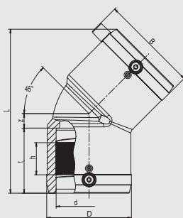
Имеет открытую нагревательную спираль для оптимальной теплопередачи, большую глубину сопряжения, особо широкую зону сварки, холодные зоны по бокам и в центре, предотвращающие вытекание расплавленной массы, упрощает выравнивание несоосности труб.
