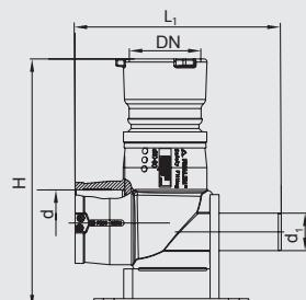
Для подключения гидранта адаптером BAIO либо к фланцу. Компактная деталь, состоящая из отвода FRIALEN 90° с подпятником (см. WF 90°) и муфтового соединения BAIO из ковкого чугуна с прокладкой. Литая муфта BAIO закреплена в полистилене неразъемно и неподвижно. Просьба следовать инструкции по монтажу для соединительной системы "BAIO". Для подземного гидранта необходимо предусмотреть защиту насадок BAIO от грязи и скручивания.
