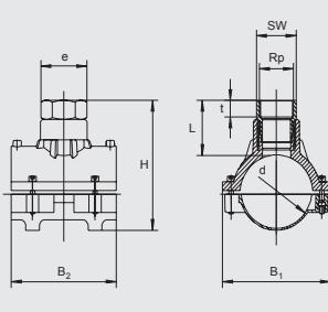
Представляет собой компактное седловое изделие из ПЭ-НД с открытым нагревательным элементом для оптимальной теплопередачи. Переход ПЭ-НД/бронза является неразъемным и надежно застопорен в ПЭ-НД от проворачивания. Служит для присоединения обычных латунных вентилей.
