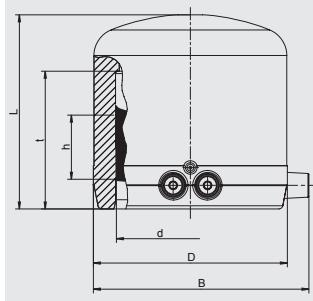
Имеет открытую нагревательную спираль для оптимальной теплопередачи, большую глубину сопряжения, особо широкую зону сварки, холодную зону на торце, предотвращающую вытекание расплавленной массы.
