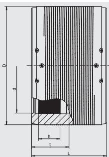
Имеет открытую нагревательную спираль для оптимальной теплопередачи, большую глубину сопряжения, особо широкую зону сварки, холодные зоны по бокам и в центре, предотвращающие вытекание расплавленной массы, упрощает выравнивание несоосности труб. С жидкостными индикаторами для визуального контроля процесса сварки.
