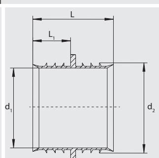
Для ремонта в безнапорном состоянии домовых вводов систем водоснабжения. Предотвращает попадание воды в сварную зону муфт FRIALEN MB или UB.
