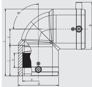
Имеет открытую нагревательную спираль для оптимальной теплопередачи, большую глубину сопряжения, особо широкую зону сварки, холодные зоны по бокам и в центре, предотвращающие вытекание расплавленной массы, упрощает выравнивание несоосности труб.
