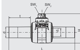
Компактное изделие из ПЭ-НД, привариваемое в процессе монтажа муфтами FRIALEN MB или UB. Не требуется мероприятий по защите от коррозии. Открытое и закрытое положения определяются упорами. Шаровый кран, не требующий технического обслуживания, управляемся с помощью монтажного набора (FRIALEN - BS).
