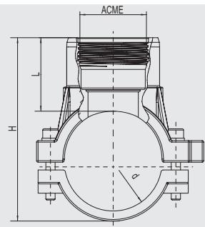
Компактный седловой фитинг с резьбовым отверстием для присоединения систем полива газонов, например: игровых полей или полей для гольфа. Имеет открытый нагревательный элемент для оптимальной теплопередачи. Встроенная латунная гильза с резьбой для безопасного соединения с фитингами ПВХ.
