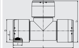
Имеет открытую нагревательную спираль для оптимальной теплопередачи на всех 3 выходах, большую глубину сопряжения, особо широкую зону сварки, холодные зоны по бокам и в центре, предотвращающие вытекание расплавленной массы, упрощает выравнивание несоосности труб. Раздельные зоны сварки. Разгрузка на строительной площадке производится легко благодаря приваренным проушинам.
