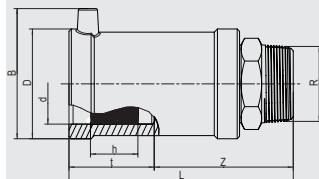
Компактное изделие. Часть ПЭ-НД имеет открытый нагревательный элемент для оптимальной теплопередачи, большую глубину сопряжения, особо широкую зону сварки, а также холодную зону, предотвращающую вытекание расплавленной массы на торце и в области перехода, упрощает выравнивание несоосности труб. Резьбовая часть из стали неразъемная и надежно закреплена от прокручивания в ПЭ-НД. Запатентованная технология обжима позволяет обеспечить герметичность без применения эластомерных уплотнений.
