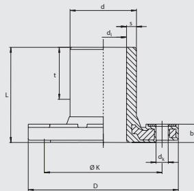
Бурт под фланец и фланец представляют собой единое целое. Металлическая вставка во фланце для предотвращения явлений холодной текучести. Патрубок для монтажа при помощи муфт FRIALEN MB или UB. Рекомендуется применять эластомерные уплотнения со стальными сердечниками. Необходимы дополнительные шайбы для болтов.
