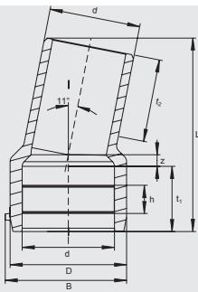
Для универсального и свободного от внутренних напряжений корректирования направления трубопровода, в т.ч. и в стесненных условиях. Достигается максимальная универсальность благодаря вариантам монтажа. Путем комбинации возможно создание отводов 22°, 33° и т.д. Муфтовая часть имеет открытую нагревательную спираль для оптимальной теплопередачи, большую глубину сопряжения, особо широкую зону сварки. Спиготная часть подходит для сварки с помощью муфт FRIALEN MB/UB.
