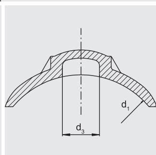
Для адаптации к трубам всех диаметров указанного диапазона с помощью прижимного приспособления FRIATOP (см. раздел FRIATOOLS арт.613350). ПЭ-НД седловина для ремонта небольших повреждений труб с и без выхода среды. Для предотвращения выхода среды должна применяться отдельная заглушка\* ( $< d_3$ ). С открытым нагревательным элементом для оптимальной теплопередачи.
