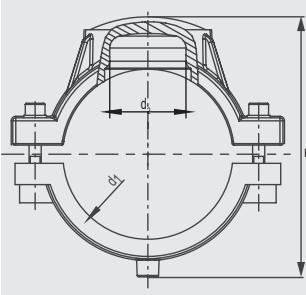
Компактное изделие из двух ПЭ-НД седловин для ремонта небольших повреждений труб и без выхода транспортируемой среды. С открытым нагревательным элементом для оптимальной теплопередачи.
