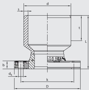
Компактное изделие из ПЭ-НД, представляющее собой комбинацию ввариваемого фланца EFL и редукционной муфты. Специально предназначено для соединения фланцевой арматуры с тройниками с переходом на DN 80 и DN 100. Для вертикального соединения гидрантов в комбинации WF 90° d 110 или тройником. Нужно следить за монтажной высотой. Без внутреннего грата в месте сварного стыка. Размеры фланца согласно DIN 2501, часть 1.
