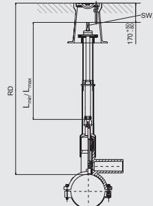
Телескопическая приводная штанга для управления вентилем FRIALEN - DAV с уличного люка (ковера). В заданном диапазоне (RD) бесступенчато регулируется без инструментов, что также возможно в смонтированном состоянии. Самостопорится в любом выдвинутом положении. Защищена от коррозии.
