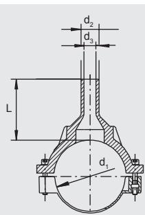
Компактное изделие из ПЭ-НД седловой формы с открытым нагревательным элементом для оптимальной теплопередачи и выходным патрубком для монтажа при помощи муфт FRIALEN MB или UB. Врезка выполняется в безнапорном состоянии с помощью подходящего приспособления для врезки. Мы рекомендуем Huetz & Baumgarten ([www.huetz-baumgarten.de](http://www.huetz-baumgarten.de)).
