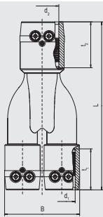
Разветвитель для труб (Y-образный тройник) в компактном исполнении с тремя электросварными зонами с открытыми нагревательными элементами для оптимальной передачи тепла на трубу.
