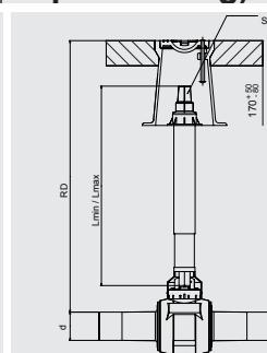
Телескопическая приводная штанга для управления кранами FRIALEN - КН, КНР, АКНР и АКНР-TL через ковер. В заданной области (RD) бесступенчатая установка по высоте, даже в смонтированном состоянии. Самофиксирующийся шток при любом положении вытяжения. Устойчив к коррозии. Исполнение с ключом 14 – специально для домовых вводов.
