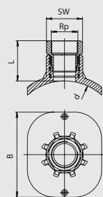
Применяется для адаптации ко всем диаметрам труб в заданной области с помощью прижимного приспособления FRIATOP (см. раздел FRIATOOLS арт.613350). Компактное изделие. Представляет собой седловое изделие из ПЭ-НД с открытым нагревательным элементом для оптимальной теплопередачи. Переход ПЭ-НД/бронза (красное литье) является неразъемным и надежно застопорен в ПЭ-НД от проворачивания. Служит для присоединения обычных латунных вентилей.
