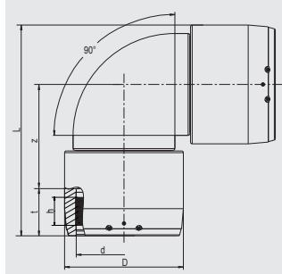
Имеет открытую нагревательную спираль для оптимальной теплопередачи, большую глубину сопряжения, особо широкую зону сварки, холодные зоны по бокам и в центре, предотвращающие вытекание расплавленной массы, упрощает выравнивание несоосности труб. Раздельные зоны сварки. Разгрузка на строительной площадке производится легко благодаря приваренным болтам с проушиной.
