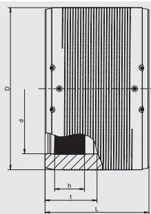
Имеет открытую нагревательную спираль для оптимальной теплопередачи, большую глубину сопряжения, широкую зону сварки, холодные зоны по бокам и в центре, предотвращающие вытекание расплавленной массы, упрощает выравнивание несоосности труб. Сварка труб SDR 11 - SDR 7.4.
