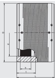
Имеет открытую нагревательную спираль для оптимальной теплопередачи, большую глубину сопряжения, особо широкую зону сварки, холодные зоны по бокам и в центре, предотвращающие вытекание расплавленной массы, упрощает выравнивание несоосности труб. С жидкостными индикаторами для визуального контроля процесса сварки. Для сварки UB d1000 и более подходит исключительно сварочный аппарат FRIAMAT XL.
