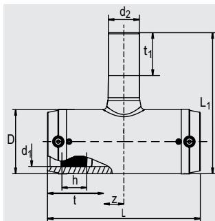
Имеет открытую нагревательную спираль для оптимальной теплопередачи, большую глубину сопряжения, особо широкую зону сварки, холодные зоны по бокам и в центре, предотвращающие вытекания расплавленной массы, упрощает выравнивание несоосности труб. Отводные патрубки SDR 11 для приварки муфтами UB/MB.
