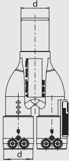
Разветвитель для труб (Y-образный тройник) в компактном исполнении с двумя электросварными зонами и ПЭ-патрубком спигот на конце для соединения труб, например, через отвод FRIALEN 90°.
