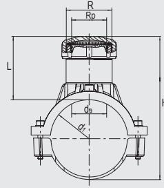
Компактное изделие для использования вместе с воздушно-камерными запорными приспособлениями. Представляет собой седловое изделие из ПЭ-НД с открытым нагревательным элементом, что способствует оптимальной теплопередаче. Латунная резьбовая часть является неразъемной и надежно застопорена от проворачивания в ПЭ-НД. Латунная заглушка имеет внутренний четырехграннык. Защита от доступа путем приварки к надстройке заглушки FRIALEN - SPAK (для d 63 мм применяется заглушка K).
