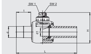
Компактное изделие из ПЭ-НД, привариваемое в процессе монтажа муфтами FRIALEN MB или UB. Проход крана соответствует внутреннему диаметру трубы. Не требуется мероприятий по защите от коррозии. Открытое и закрытое положения определяются упорами. Шаровый кран, не требующий технического обслуживания, управляемся с помощью монтажного набора (FRIALEN - BS).
