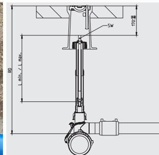
Телескопическая приводная штанга для управления вентилем FRIALEN - DAV с уличного люка (ковера). В заданном диапазоне (RD) бесступенчато регулируется без инструментов, что также возможно в смонтированном состоянии. Самостопорится в любом выдвинутом положении. Защищена от коррозии.
