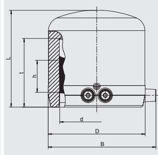
Имеет открытую нагревательную спираль для оптимальной теплопередачи, большую глубину сопряжения, особо широкую зону сварки, холодную зону на торце, предотвращающую вытекание расплавленной массы, упрощает выравнивание несоосности труб.
