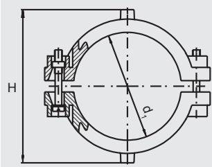
Компактное изделие из двух ПЭ-НД седловин для ремонта небольших повреждений труб без утечки транспортируемой среды. С открытым нагревательным элементом для оптимальной теплопередачи.
