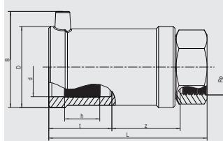
Компактное изделие. Часть ПЭ-НД имеет открытый нагревательный элемент для оптимальной теплопередачи, большую глубину сопряжения, особо широкую зону сварки, а также холодную зону, предотвращающую вытекание расплавленной массы на торце и в области перехода, упрощает выравнивание несоосности труб. Резьбовая часть из стали неразъемная и надежно закреплена от прокручивания в ПЭ-НД. Запатентованная технология обжима позволяет обеспечить герметичность без применения эластомерных уплотнений.
