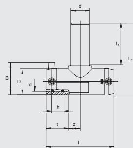
Прямой проход имеет открытую нагревательную спираль для оптимальной теплоотдачи, большую глубину сопряжения, особо широкую зону сварки, а также предотвращающие вытекание расплавленной массы холодные зоны сварки по бокам и в центре. Удлиненный отводной патрубок рассчитан на 2 сварки.
