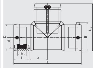
Имеют открытую нагревательную спираль для оптимальной теплопередачи на всех 3 выходах, большую глубину сопряжения, особо широкую зону сварки, холодные зоны по бокам и в центре, предотвращающие вытекание расплавленной массы, упрощает выравнивание несоосности труб. Линейная сторона сваривается за одну операцию, вследствие этого на соединение всего изделия необходимо только 2 сварочные операции.
