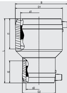
Имеет открытую нагревательную спираль для оптимальной теплопередачи, большую глубину сопряжения, особо широкую зону сварки, холодные зоны по бокам и в центре, предотвращающие вытекание расплавленной массы, упрощает выравнивание несоосности труб.
