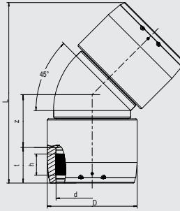
Имеет открытую нагревательную спираль для оптимальной теплопередачи, большую глубину сопряжения, особо широкую зону сварки, холодные зоны по бокам и в центре, предотвращающие вытекание расплавленной массы, упрощает выравнивание несоосности труб. Раздельные зоны сварки. Разгрузка на строительной площадке производится легко благодаря приваренным болтам с проушиной.
