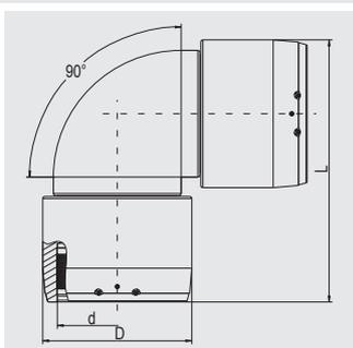
Имеют открытую нагревательную спираль для оптимальной теплопередачи, большую глубину сопряжения, особо широкую зону сварки, холодные зоны по бокам и в центре, предотвращающие вытекание расплавленной массы, не требуют при работе специальных позиционеров и приспособлений. Раздельные сварочные зоны.
