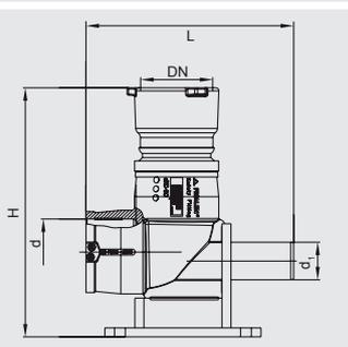
Для подключения гидранта с литым концом. Компактная деталь, состоящая из отвода FRIALEN 90° с подпятником (сравни с WF 90°) и муфтового соединения NOVO-SIT из ковкого чугуна с прокладкой типа Tyton и крепежного кольца для обеспечения прочности на скалывание. Литая муфта NOVO-SIT закреплена в полиэтилене неразъемно и неподвижно. Просим следовать инструкциям по монтажу для соединительной системы NOVO-SIT.
