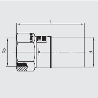
Компактное изделие. Полиэтиленовая часть дает возможность производить монтаж вне зависимости от положения и обеспечивает герметичное сварное соединение со всеми подходящими фасонными изделиями FRIALEN. Латунная часть неразъемна и надежно без возможности проворачивания соединена с полиэтиленовой. Сертифицировано DVGW, Пер.-Nr. DV-7501AU2256, DV-7501AU2257.
