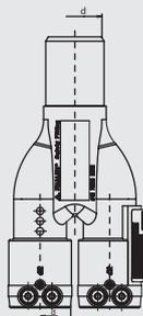
Разветвители для труб (Y-вилки) в компактном дизайне с двумя сварными зонами и ПЭ-патрубком спигот на конце для соединения труб, например через отвод FRIALEN 90°.
