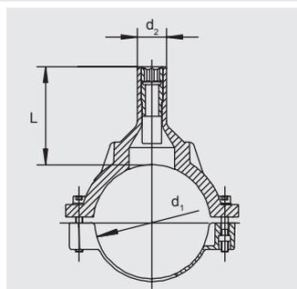
Компактное изделие седловой формы из ПЭ-ВП с открытым нагревательным элементом для оптимальной теплопередачи и выходным патрубком для FRIALEN - муфт типа MB или UB. Врезка без стружки в безнапорном состоянии при помощи интегрированной фрезы.
