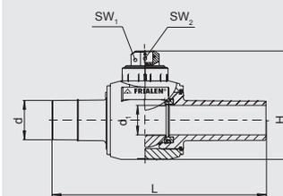
Компактное изделие из ПЭ-ВП, привариваемое в процессе монтажа FRIALEN - муфтами MB или UB. Проход крана соответствует внутреннему диаметру трубы. Не требуется мероприятий по защите от коррозии. Открытое и закрытое положения определяются упорами. Запорный кран, не требующий технического обслуживания, управляется с помощью штанги (например FRIALEN - BS). Сертифицировано DVGW, рег. Nr. DG-8631AU2251, DG-8631AU2252.
