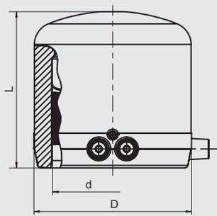
Имеет открытую нагревательную спираль для оптимальной теплопередачи, большую глубину сопряжения, особо широкую зону сварки, холодную зону на торце, предотвращающую вытекание расплавленной массы. Начиная с d 180 имеют жидкостные индикаторы для визуального контроля процесса сварки.
