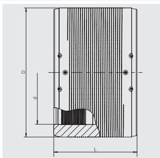
С открытой нагревательной спиралью для оптимальной передачи тепла, большая глубина вставки, широкие сварные зоны, широкие холодные зоны на концах и в середине для удержания давления расплава, монтаж возможен без дополнительных устройств. С индикаторами для визуального контроля сварки.
