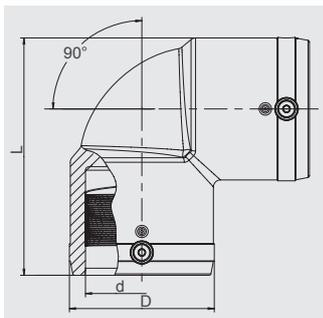
Имеют открытую нагревательную спираль для оптимальной теплопередачи, большую глубину сопряжения, особо широкую зону сварки, холодные зоны по бокам и в центре, предотвращающие вытекание расплавленной массы, не требуют при работе специальных позиционеров и приспособлений.
