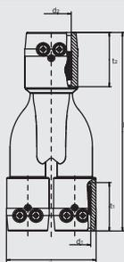
Разветвители для труб (Y-вилки) в компактном дизайне с тремя сварными зонами с открытыми нагревательными элементами для оптимальной передачи тепла на трубу.
