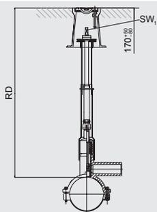
Телескопическая приводная штанга для управления вентилем FRIALEN - DAV с уличного люка. В заданном диапазоне (RD) бесступенчато регулируется без инструментов, что также возможно в смонтированном состоянии. Самостопорится в любом положении. Защищена от коррозии.
