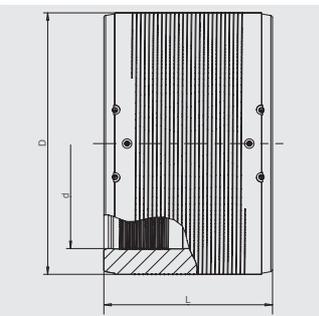
Имеет открытую нагревательную спираль для оптимальной теплопередачи, большую глубину сопряжения, особо широкую зону сварки, холодные зоны по бокам и в центре, предотвращающие вытекание расплавленной массы, не требуют при работе специальных держателей и приспособлений. С жидкостными индикаторами для визуального контроля процесса сварки. Для сварки UB d1000 и более предназначен исключительно сварочный аппарат FRIAMAT XL.
