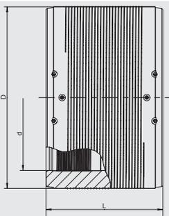
Предназначены для перехода со стандартной трубы на трубу для релайнинга. Имеют открытую нагревательную спираль для оптимальной теплопередачи, большую глубину сопряжения, особо широкую зону сварки, холодные зоны по бокам и в центре. С отдельными сварными зонами. Уменьшение зазора между трубой и муфтой при монтаже возможно при применении технологии предварительного прогрева. См. руководство по монтажу для муфт для релайнинга.
