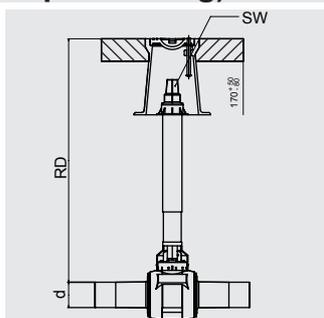
Телескопическая приводная штанга для управления кранами FRIALEN - КН, КНР, АКНР и АКНР-TL через ковер. В заданной области (RD) бесступенчатая установка по высоте, также в смонтированном состоянии. Самофиксирующийся при любом положении вытяжения. Устойчив к коррозии. **Исполнение со шпинделем 14 – специально для домовых подключений.**
