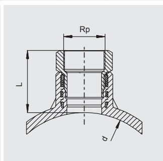
Применяется для адаптации ко **всем** диаметрам труб в заданной области с помощью прижимного приспособления FRIALEN FRIATOP (см. прайс-лист на приборы и технику FRIATOOLS). Компактное изделие. Представляет собой седловину из ПЭ-ВП с открытым нагревательным элементом для оптимальной теплопередачи. Переход ПЭ-ВП/красное литье является неразъемным и надежно застопорен в ПЭ-ВП от проворачивания. Служит для присоединения обычных латунных вентиляей.
