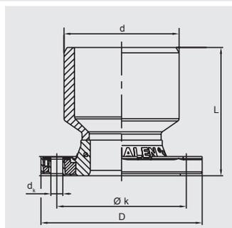
Компактное изделие из ПЭ-ВП, представляющее собой комбинацию свариваемого фланца EFL и редукции. Специально предназначено для горизонтального соединения фланцевой арматуры к тройниками FRIALLEN для редукционного перехода на DN 80 и DN 100. Для вертикального соединения гидрантов в комбинации с нашим отводом 90° и гидрантным подпятником WF 90° d 110 или тройником нужно следить за высотой перекрытия! Без внутреннего грата в месте стыка. Размеры фланца согласно DIN 2501, часть 1.
