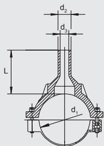
Компактное изделие из ПЭ-ВП седловины с открытым нагревательным элементом для оптимальной теплопередачи и выходным патрубком для монтажа вместе с FRIALEN - муфтами типа MB или UB. Врезка выполняется в безнапорном состоянии с помощью подходящего приспособления для врезки Мы рекомендуем Huetz & Baumgarten ([www.huetz-baumgarten.de](http://www.huetz-baumgarten.de)).
