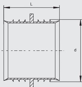
Для ремонта в безнапорном состоянии домовых вводов водопроводов. Предотвращает попадание воды в сварную зону FRIALEN - муфта типа MB и UB.
