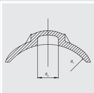
Для адаптации к трубам всех диаметров указанного диапазона с помощью прижимного приспособления FRIALEN FRIATOP (см. прайс-лист на приборы и технику FRIATOOLS). ПЭ-ВП седловина для ремонта небольших повреждений труб с и без выхода среды. Для предотвращения выхода среды должна применяться отдельная пробка\* ( $\leq d_3$ ). С открытым нагревательным элементом для оптимальной теплопередачи.
