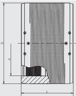
Имеет открытую нагревательную спираль для оптимальной теплопередачи, большую глубину сопряжения, особо широкую зону сварки, холодные зоны по бокам и в центре, предотвращающие вытекание расплавленной массы, не требуют при работе специальных держателей и приспособлений. С жидкостными индикаторами для визуального контроля процесса сварки.
