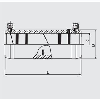
Муфты надежность-ПЛЮС, имеющие много плюсов в отношении безопасности. Имеют открытую нагревательную спираль для оптимальной теплопередачи, особо большую глубину сопряжения, особо широкую зону сварки, особо большие холодные зоны по бокам и в центре, обеспечивают оптимальное сопряжение с трубами с изогнутыми концами (из бухт), не требуют при работе специальных позиционеров и приспособлений.
