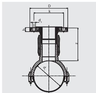
Компактное изделие из ПЭ-ВП. Представляет собой комбинацию из патрубка-накладки FRIALEN и привариваемого фланца тип EFL. Седловина с открытым нагревательным элементом для оптимальной теплопередачи. Врезка производится в безнапорный трубопровод или с использованием обычных для этих целей приспособлений. Мы рекомендуем Huetz & Baumgarten ([www.huetz-baumgarten.de](http://www.huetz-baumgarten.de)). Фланец изготовлен в соответствии с DIN 2501, ч.1. Мы рекомендуем прокладку GST.
