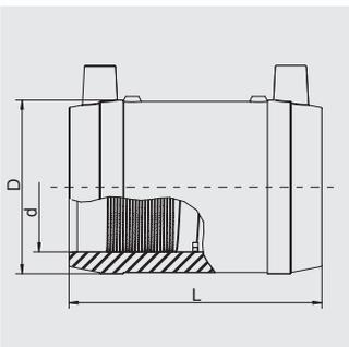
Применяются также как ремонтные муфты. Имеют открытую нагревательную спираль для оптимальной теплопередачи, большую глубину сопряжения, особо широкую зону сварки, холодные зоны по бокам и в центре, предотвращающие вытекание расплавленной массы, не требуют при работе специальных позиционеров и приспособлений.
