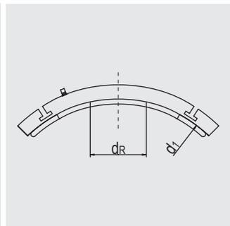
Компактное изделие из ПЭ-ВП для ремонта таких повреждений, как царапины, канавки или проникновения трубы. Накладка с открытой нагревательной спиралью для оптимальной теплопередачи. Для монтажа с помощью монтажного приспособления VACUSET XL (см. прайс-лист на приборы и технику FRIATOOLS). С жидкостными индикаторами для визуального контроля процесса сварки. Повреждение должно находиться внутри заданной для ремонта поверхности  $d_R$  и не должно перекрываться зоной сварки.
