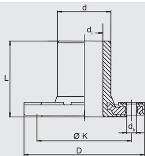
Ввариваемый буртик и фланец представляют собой цельное фланцевое изделие. Металлическая вставка во фланце для предотвращения явлений холодной текучести. Привариваемая часть пригодна для работы с FRIALEN - муфтами типа MB и UB. Размеры фланца согласно DIN 2501, часть 1. Рекомендуются уплотнения GST. **Необходимы дополнительные шайбы.**
