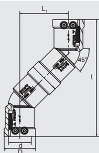
Компактное изделие для соединения трубопроводов, не параллельно стыкующихся друг с другом, а также для соединения домового ввода с арматурой для врезки под давлением DAA или DAV при параллельной прокладке второй магистрали с одинаковой глубиной укладки и цокольного ввода.
