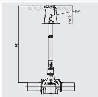
Телескопическая приводная штанга для управления FRIALOC – запорной арматуры из ПЭ для использования с ковером. Оптимально подогнаны друг к другу. В заданной области (RD) бесступенчатая установка по высоте. Простой монтаж посредством применения фиксирующей защелки. Исполнение- из оцинкованной или нержавеющей стали.
