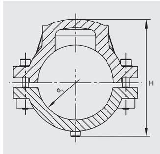
Компактное изделие из двух ПЭ-ВП седловин для ремонта небольших повреждений труб **с и без** выхода транспортируемой среды. Для предотвращения попадания транспортируемой среды в зону сварки, поврежденное место глушится дополнительной пробкой\* ( $\leq d_3$ ). С открытым нагревательным элементом для оптимальной теплопередачи.
