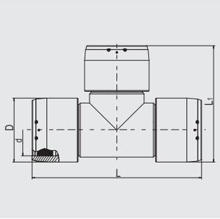
Имеют открытую нагревательную спираль для оптимальной теплопередачи на всех 3 выходах, большую глубину сопряжения, особо широкую зону сварки, холодные зоны по бокам и в центре, предотвращающие вытекание расплавленной массы, не требуют при работе специальных позиционеров и приспособлений. Раздельные сварочные зоны.
