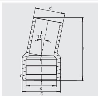
Для универсального и свободного от внутренних напряжений корректирования направления трубопровода, в т.ч. и в стесненных условиях. Достигается максимальная универсальность благодаря вариантам монтажа. Путем комбинации возможно создание отводов 22°, 33° и т.д.
