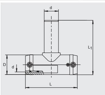
Прямой проход имеет открытую нагревательную спираль для оптимальной теплоотдачи, большую глубину сопряжения, особо широкую зону сварки, а также предотвращающие вытекание расплавленной массы холодные зоны сварки на торцах и в середине для сварки без позиционеров. Удлиненный отводной патрубок рассчитан на 2 сварки.
