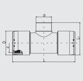
Имеют открытую нагревательную спираль для оптимальной теплопередачи, большую глубину сопряжения, особо широкую зону сварки, холодные зоны по бокам и в центре, предотвращающие вытекание расплавленной массы, не требуют при работе специальных позиционеров и приспособлений. Раздельные зоны сварки. Отводные патрубки SDR11 для приварки муфтами UB/MB. Другие диаметры выходных патрубков можно получить с помощью редукционных муфт MR d225/160, MR 110/90 или MR 110/63.
