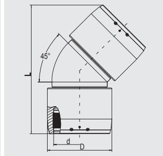
Имеют открытую нагревательную спираль для оптимальной теплопередачи, большую глубину сопряжения, особо широкую зону сварки, холодные зоны по бокам и в центре, предотвращающие вытекание расплавленной массы, не требуют при работе специальных позиционеров и приспособлений. Раздельные сварочные зоны.
