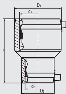
Имеют открытую нагревательную спираль для оптимальной теплопередачи, большую глубину сопряжения, особо широкую зону сварки, холодные зоны по бокам и в центре, предотвращающие вытекание расплавленной массы, не требуют при работе специальных позиционеров и приспособлений.
