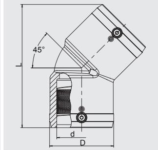
Имеют открытую нагревательную спираль для оптимальной теплопередачи, большую глубину сопряжения, особо широкую зону сварки, холодные зоны по бокам и в центре, предотвращающие вытекание расплавленной массы, не требуют при работе специальных позиционеров и приспособлений.
