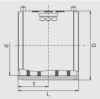
Открытая нагревательная спираль для оптимальной теплопередачи во время сварки, большая глубина сопряжения, очень широкие зоны сварки и холодные зоны на концах и в середине для предотвращения вытекания расплава и для использования без применения позиционеров.
