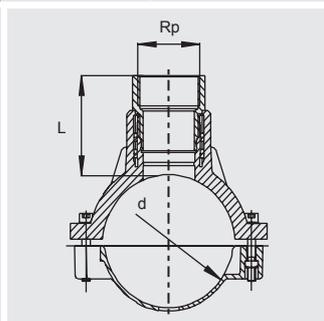
Компактное изделие. Представляет собой седловину из ПЭ-ВП с открытым нагревательным элементом для оптимальной теплопередачи. Переход ПЭ-ВП/красное литье является неразъемным и надежно застопорен в ПЭ-ВП от проворачивания. Служит для присоединения обычных латунных вентиляей.
