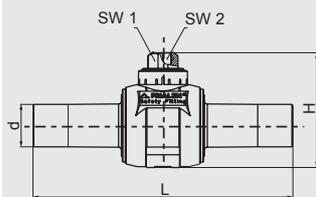
Компактное изделие из ПЭ-ВП, привариваемое в процессе монтажа FRIALEN - муфтами MB или UB. Не требуется мероприятий по защите от коррозии. Открытое и закрытое положения определяются упорами. Запорный кран, не требующий технического обслуживания, управляется с помощью штанги (например FRIALEN - BS). Сертифицировано DVGW, рег. Nr. DG-8631AU2251, DG-8631AU2252 и DG-8631AU2253.
