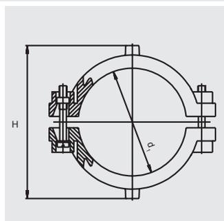
Компактное изделие из двух ПЭ-ВП седловин для ремонта небольших повреждений труб **без** утечки транспортируемой среды. С открытым нагревательным элементом для оптимальной теплопередачи.
