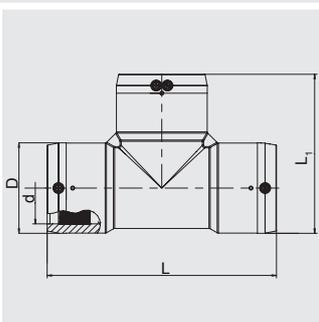
Имеют открытую нагревательную спираль для оптимальной теплопередачи на всех 3 выходах, большую глубину сопряжения, особо широкую зону сварки, холодные зоны по бокам и в центре, предотвращающие вытекание расплавленной массы, не требуют при работе специальных позиционеров и приспособлений. Прямоточная сторона сваривается за одну установку сварочного аппарата, вследствие этого необходимы только 2 сварки.
