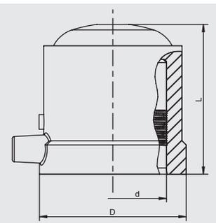
Имеют открытую нагревательную спираль для оптимальной теплоотдачи, большую глубину сопряжения, особо широкую зону сварки, а также предотвращающую вытекание расплавленной массы холодную зону на торце.
