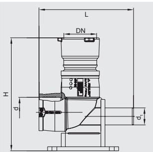
Для подключения гидранта к системе ВАИО либо к фланцу. Компактная деталь, состоящая из отвода FRIALEN 90° с подпятником (сравни с WF 90°) и муфтового соединения ВАИО из ковкого чугуна с прокладкой. Литая муфта ВАИО закреплена в полиэтилене неразъемно и неподвижно. Просьба следовать инструкции по монтажу для соединительной системы "ВАИО". Для подземного гидранта необходимы защита насадок ВАИО от грязи и скручивания.
