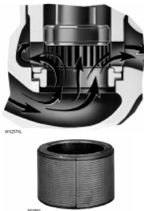
Рисунок 8. Конструкция установочных элементов для снижения аэродинамических шумов
