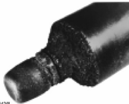
Рисунок 7. Типичный вид повреждения клапана кавитацией
