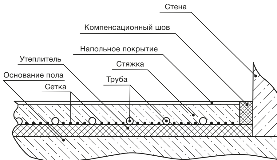
Рисунок 24. Схема устройства системы «Теплый пол»
