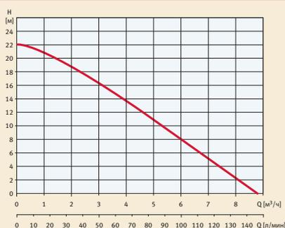
→ Для отвода хозяйственно-бытовых и фекальных стоков с пищевыми отходами. Применяются в частных домах, кафе, ресторанах, гостиницах и т.п. Режущий механизм расположен в нижней части насоса.
