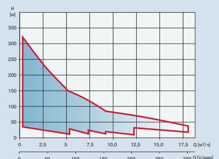
→ Для подъёма воды из скважин диаметром 4". Работа в установках водоснабжения, орошения и повышения давления. Перекачивание взвешенных частиц до 300 г/куб.м.
