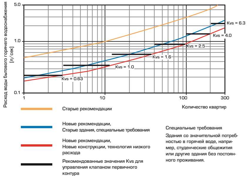
ТЕХНИЧЕСКИЕ УСЛОВИЯ - БЫТОВАЯ СИСТЕМА ГОРЯЧЕГО ВОДОСНАБЖЕНИЯ, ПЕРВИЧНЫЙ КЛАПАН В РАЙОННОМ ТЕПЛО-ВОМ ПУНКТЕ
