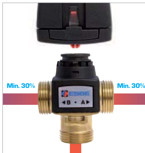
ПОСТОЯННЫЙ ПОТОК Если привод снят, то отводной клапан автоматически занимает положение, позволяющее потоку проходить в обоих контурах одновременно.
