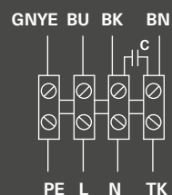
Схема 3 (Δ — 230 В, 3 ф.)
