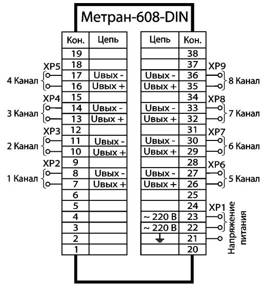
Рис.7. Схема подключения блоков Метран-608 (исполнение DIN).
