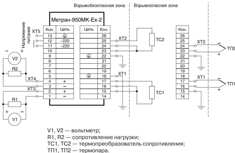
Рис. 6. Подключение двухканального Метран-950МК-Ex при измерении сигналов от термопар, термопреобразователей сопротивления с выходным сигналом 4...20 мА
