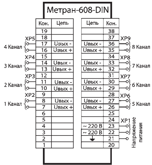
Рис.7. Схема подключения блоков Метран-608 (исполнение DIN).
