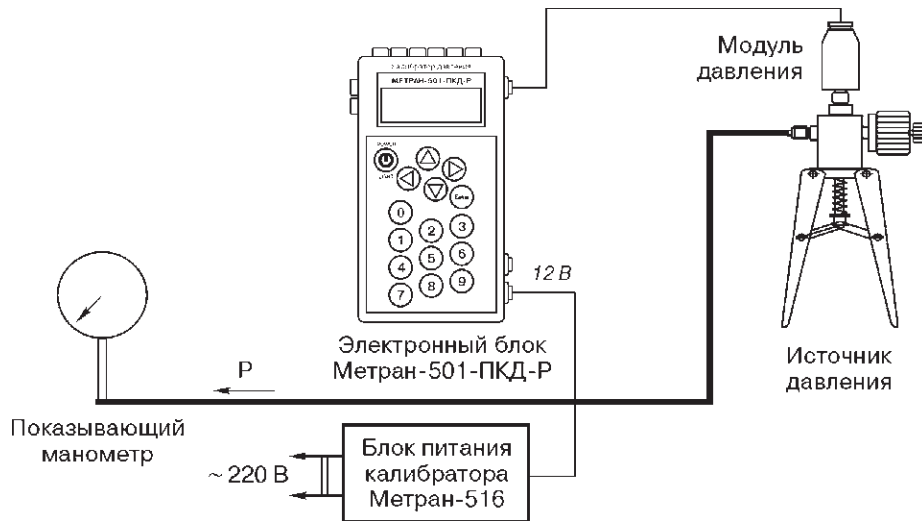
Рис. 5. Поверка и калибровка показывающих манометров.
