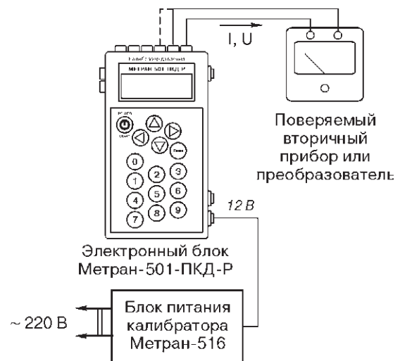
Рис. 7. Поверка и калибровка регистраторов и т.п.
