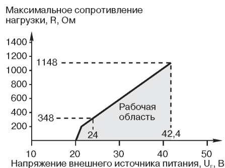
Рис.26. Диаграмма сопротивлений для уровнемера, сертифицированного на взрывобезопасность.
