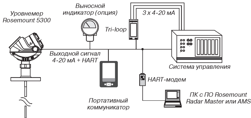
Рис.27. Интеграция в систему с использованием HART-протокола.
