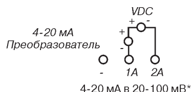
Рис. 11. Схема подключения аналогового входа к преобразователю Rosemount 848T.
