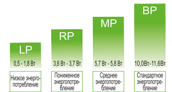
УРОВНИ ЭНЕРГОПОТРЕБЛЕНИЯ - мощность ненагретого соленоида в режиме удержания (Вт)
