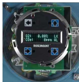
Корпус электронной части с локальным интерфейсом оператора и ИК-кнопками, нажимаемыми через стекло
