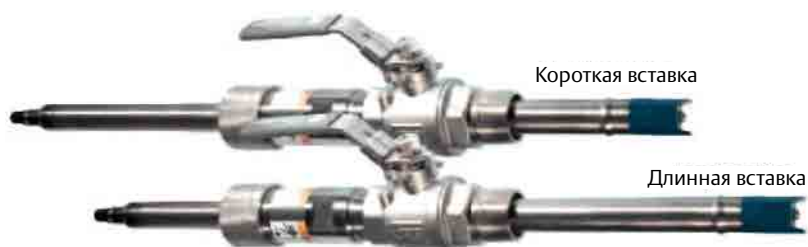
Рис. 8.3.1 Выдвижные датчики имеют важное преимущество – возможность регулирования глубины погружения. Трубки датчика можно устанавливать на малую (фото сверху) или большую глубину (фото снизу) ввода датчика в технологический процесс.
