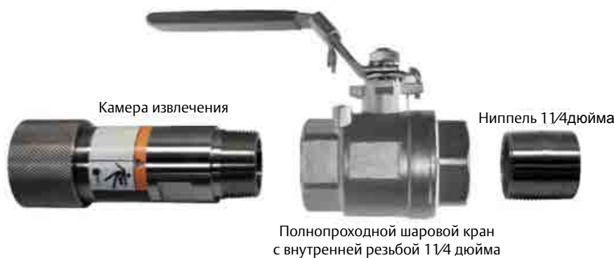
Рис. 8.3.8 Шаровой кран в комплекте (PN 23765-00 или -01) включает все детали, необходимые для установки датчика. Камера извлечения (PN 23796-00) можно купить отдельно
