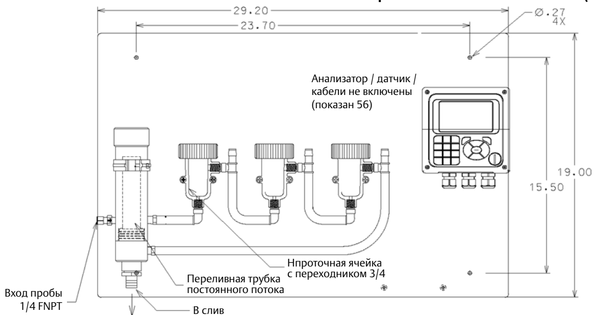
Рис. 8.7.2 Пример панели, использующей специально сконструированный контроллер постоянного потока, предназначенный для управления потоком к трем ячейкам потока. Панели с возможностью выбора одной, двух или трех ячеек потока и выбора одного или двух инструментов (показаны на рисунке 56, предлагаются под SQ 11102). Обратитесь за консультацией к изготовителю для получения более детальной информации
