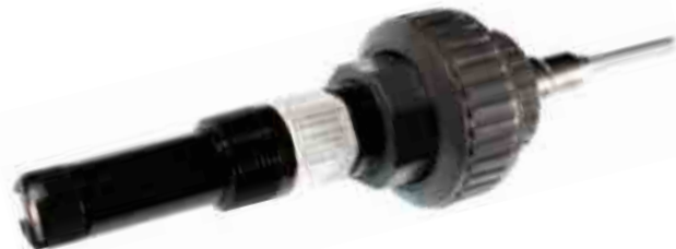
Рис. 8.2.28 Датчик растворенного кислорода 499ADOVP с переходником PN 9320057
