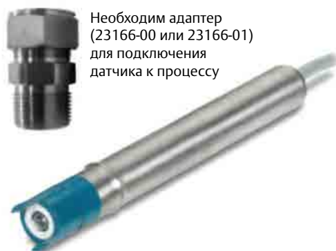
Рис. 8.0.3 Датчик 3300НТ имеет корпус без рабочих резьб. Датчик устанавливается в процесс через обжимной адаптер или устройство ввода, что обеспечивает регулировку погружения датчика. Доступно несколько длин извлекаемых датчиков
