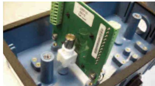
Рис. 8.5.3 Соединительная коробка PN 23555-00 используется только для датчиков рН или ОВП. Плата предварительного усилителя установлена внутри соединительной коробки
