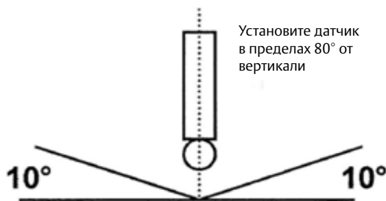
Рис. 8.1.1 Рекомендованный монтаж датчика рН
