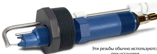
Рис. 8.2.21 Аэрозольный распылитель показан с датчиком модели 3900рН с использованием передней резьбы для подключения к очистителю и тыльной резьбы для подключения к монтажной штанге
