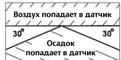
Рис. 8.3.3 Для получения точных результатов измерения соблюдайте вышеуказанные углы монтажа
