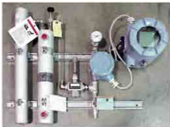
Рис. 8.10.1 Указанная заказчиком система, включая образец системы охлаждения с прибором 5081 и датчик проводимости, была создана как PN SQ 8413B
