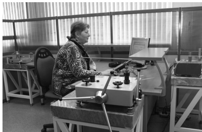
Представитель Челябинского ЦСМ проводит поверку калибратора давления
