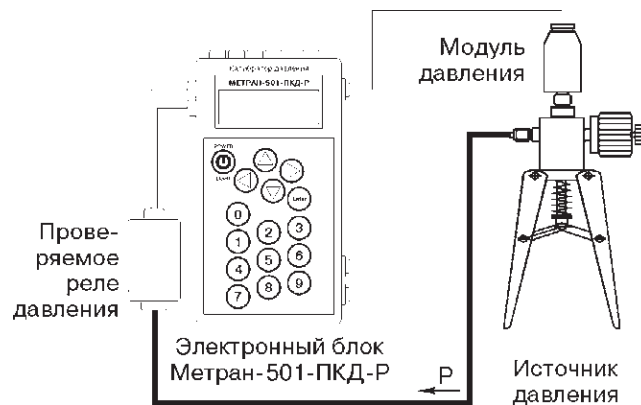
Рис. 3. Проверка реле давления.
