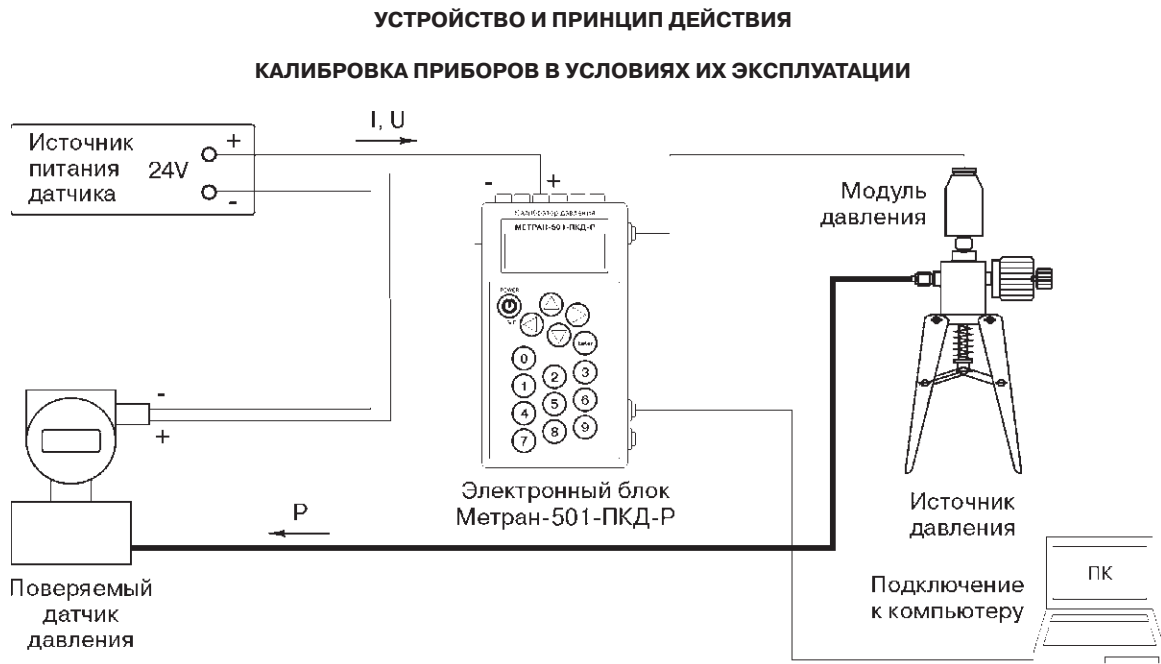
Рис. 1. Калибровка измерительных преобразователей (датчиков) давления.
