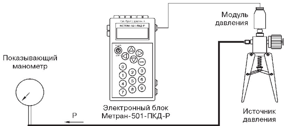
Рис. 2. Калибровка показывающих манометров.
