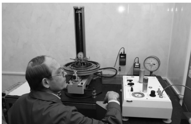
Ремонт и градуировка задатчиков давления V1600D (Pressurements, Англия). Заказчик из Норвегии
