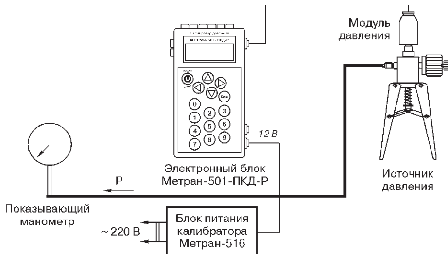
Рис. 5. Поверка и калибровка показывающих манометров.
