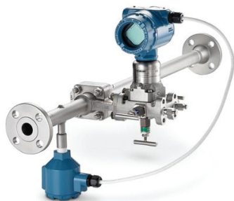
Рис. 1. Установка расходомера 3051SFP на базе встроенной диафрагмы 1195 и многопараметрического преобразователя 3051SMV с выносным монтажом термопреобразователя сопротивления Pt100
