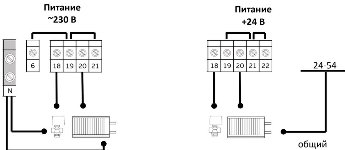
Рис. 8.1. Подключение одноконтурного фреонового охладителя без автоматики.
