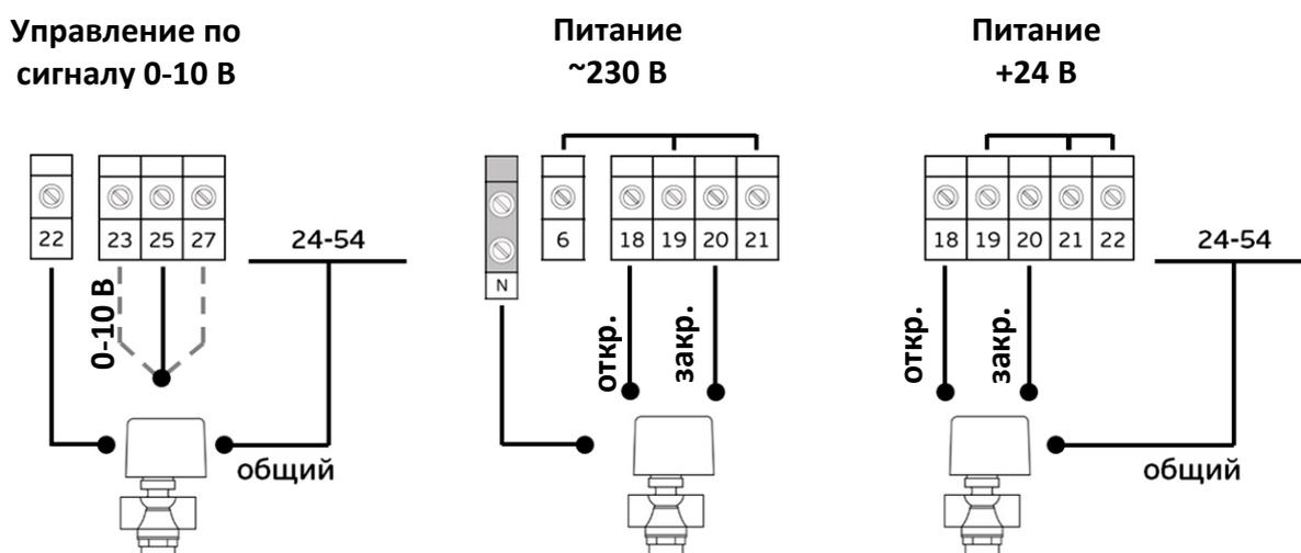
Рис. 7. Подключение привода клапана холодной воды
