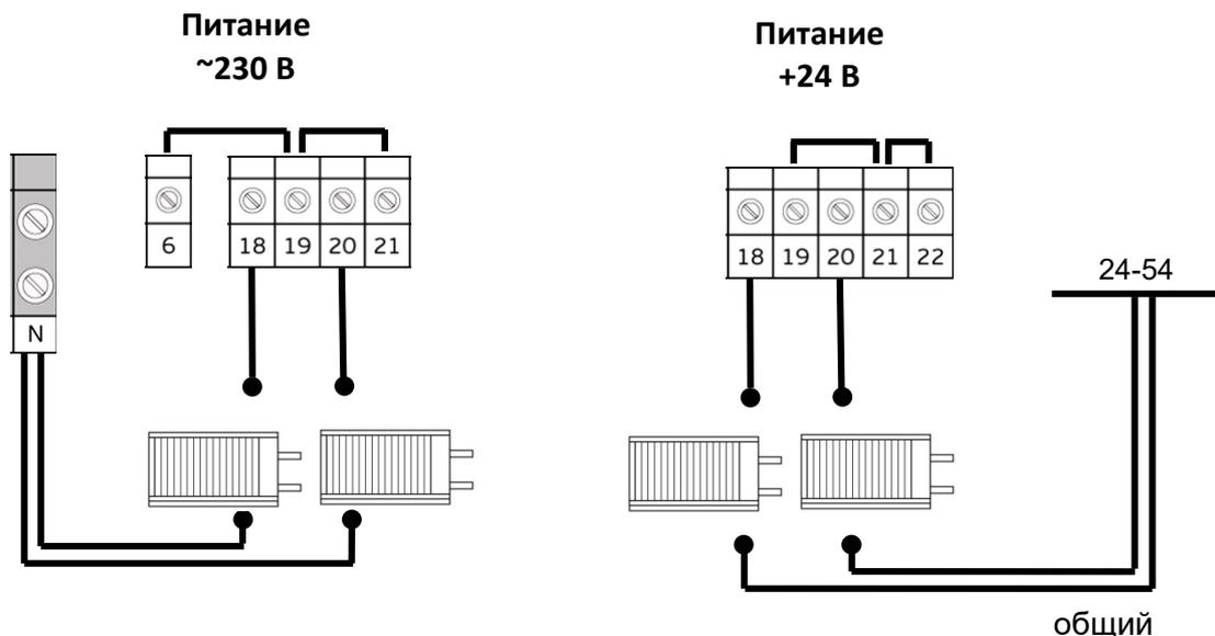
Рис. 8.2. Подключение двухконтурного фреонового охладителя с собственной автоматикой.
