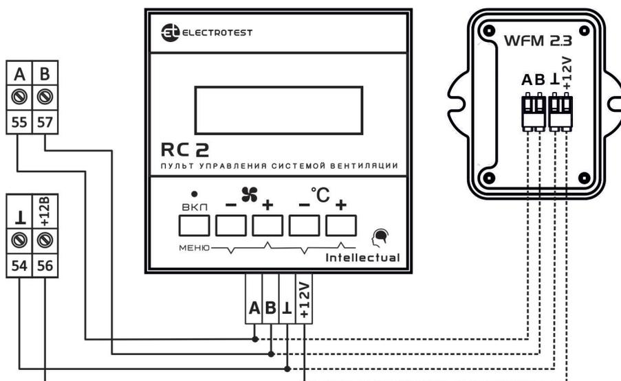
Рис. 12. Подключение пульта дистанционного управления и модуля Wi-Fi
