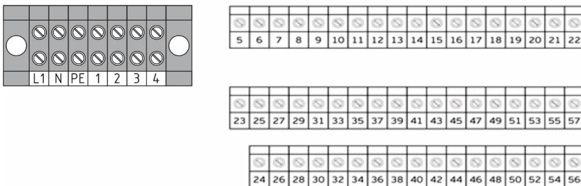
Рис. 2. Назначение клемм модуля.
