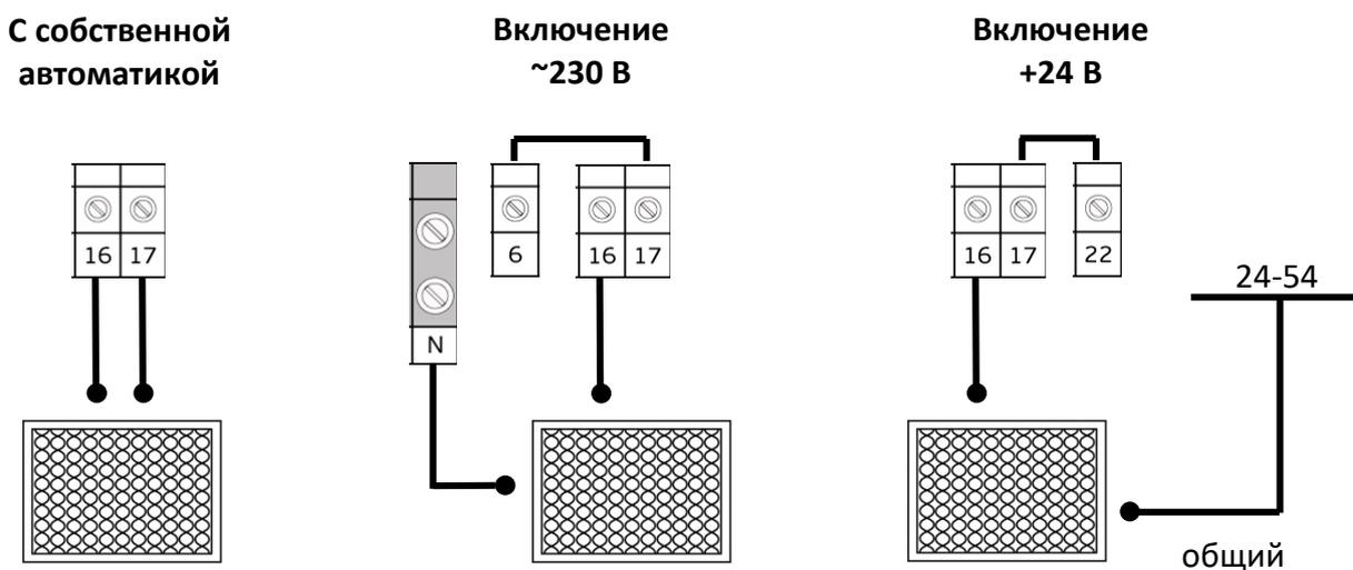
Рис. 9. Подключение увлажнителя
