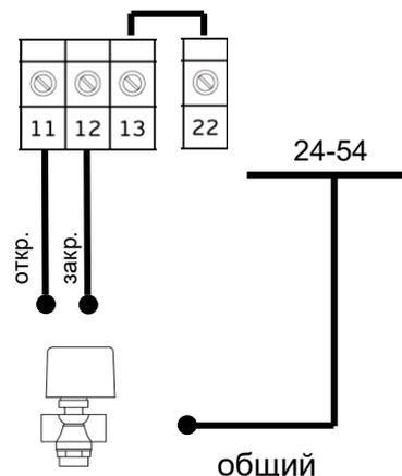
Рис. 6. Подключение привода клапана горячей воды
