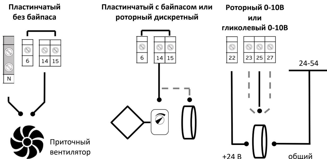
Рис. 4. Подключение рекуператора.
