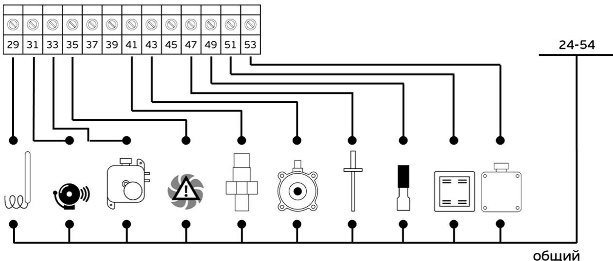
Рис. 11. Подключение датчиков.
