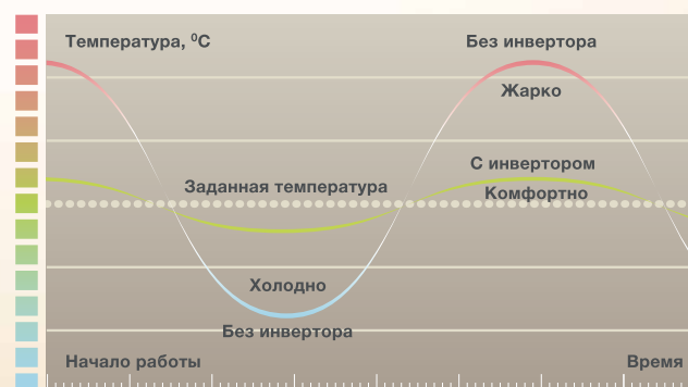
Схема работы DC инвертора
