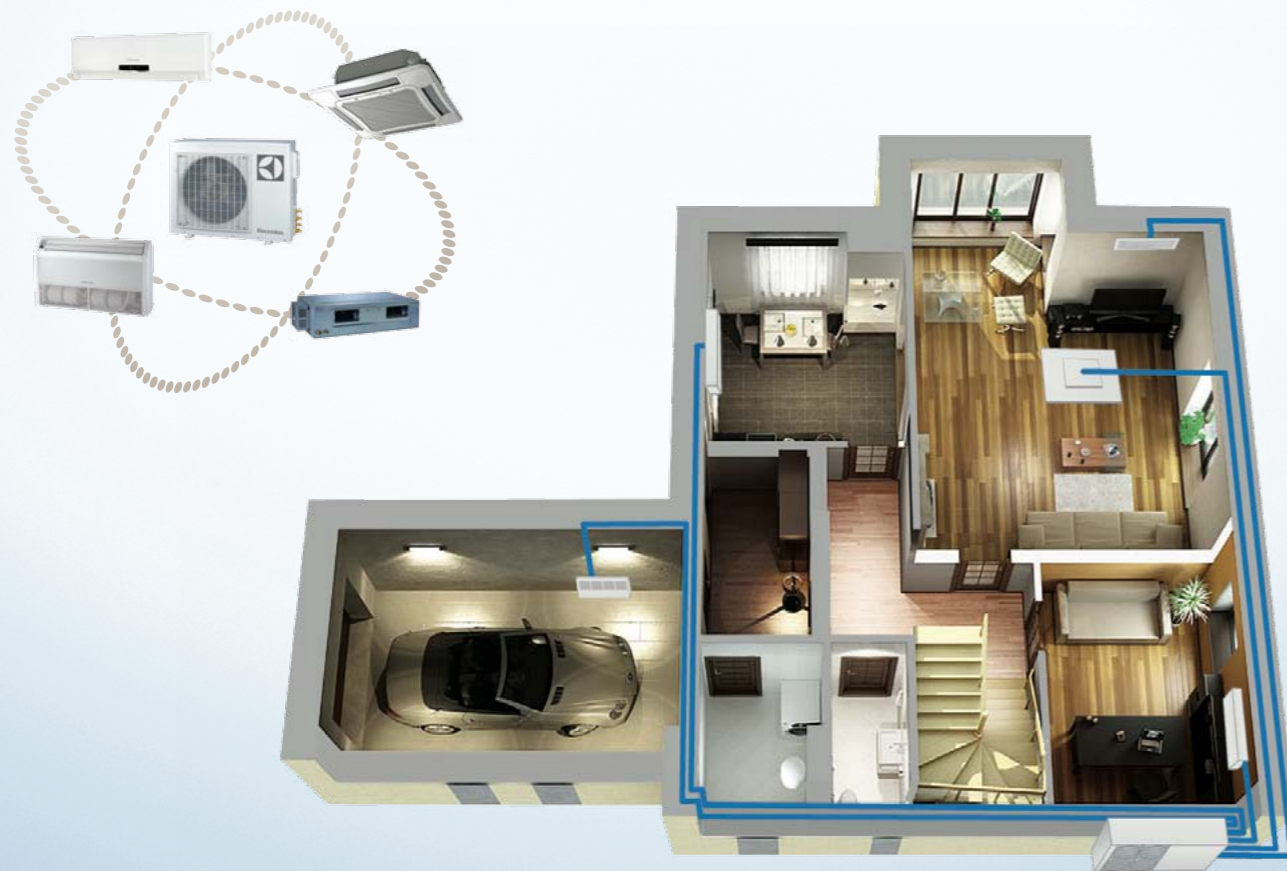
Схема работы мульти сплит-системы Super Match
