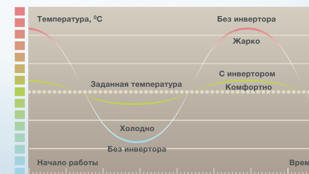
Схема работы DC инвертора
