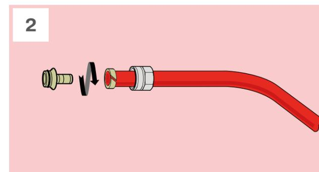
Вставить в трубу штуцер фитинга, проворачивая его по часовой стрелке, до упора.
