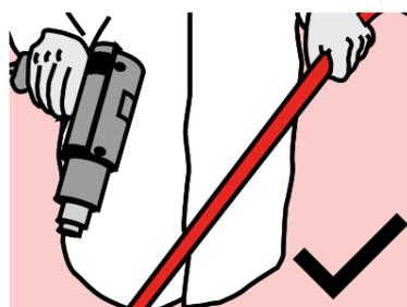
Чтобы на горячей трубе снова не появился излом, трубу следует зафиксировать в прямом положении до тех пор, пока она не остынет.
