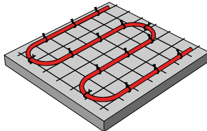
Также, достаточно удобным и интересным решением для крепежа являются гарпунные (якорные) скобы, которые фиксируют трубу к плоской теплоизоляции.
