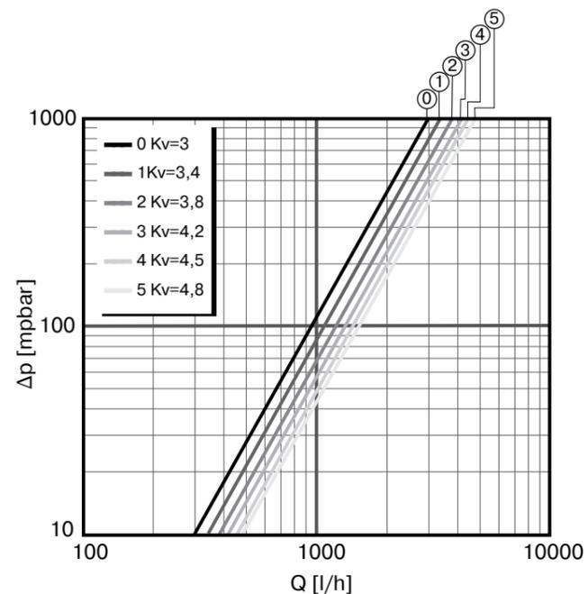
По этой диаграмме определяем соответствующие расходу теплоносителя (**G = 1724 л/час**) потери напора на смесительном узле (**ΔP\_mix**), при разных настройках байпаса.
