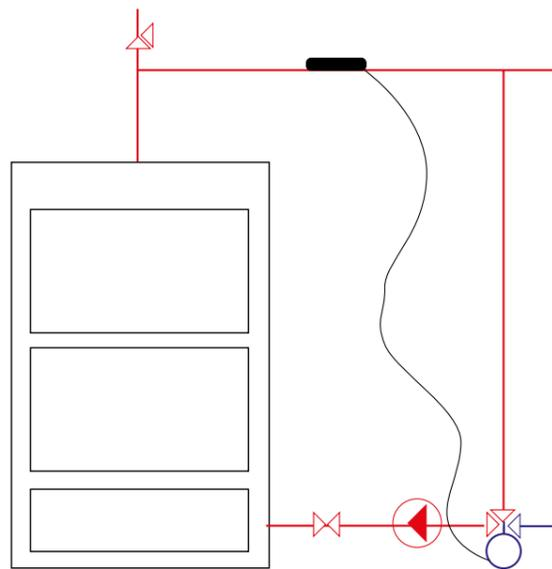
Котловой контур (твердотельный котел)
