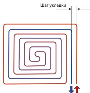
Для удобства расчётов приведена таблица с расходом труб (в погонных метрах) в зависимости от шага укладки:
