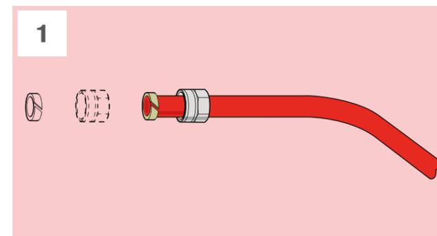
Надеть на трубу гайку фитинга, а затем фиксирующее кольцо.
