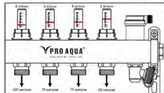
Может получиться и так, что при настройке третьей петли расход даже при полностью открытом клапане устанавливается на уровне 2,5л/мин и не доходит до положенного уровня 3л/мин. Это значит, что петля имеет большее (выше) гидравлическое сопротивление, чем вторая петля той же длины (на петле большее количество поворотов, отводов и т.д.). В данном случае эта петля принимается как расчётная, и все остальные петли выставляются относительно нее по тому же принципу:
