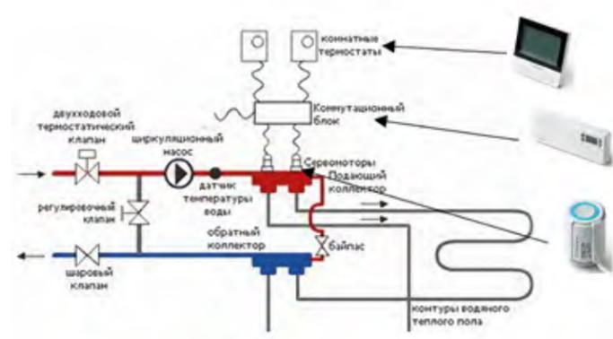
К каждому контуру теплого пола, должен быть подключен свой терморегулятор (сервопривод) поскольку все контура имеют собственный тепловой режим. Как сервопривод получит сигнал об изменении температуры в регулируемой им зоне? С помощью комнатных термостатов, которые можно подключить удаленно или через провода (в зависимости от комплектации) к сервоприводам через зональный коммуникатор.
