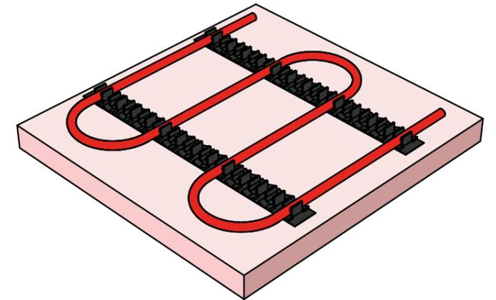
Важными элементами в системе крепежа являются фиксаторы поворота, которые рекомендуется устанавливать в местах выхода труб из стяжки для подключения к коллектору. Использование фиксаторов поворота защитит трубы от повреждений, а также снизит риск растрескивания стяжки в местах выхода труб.
