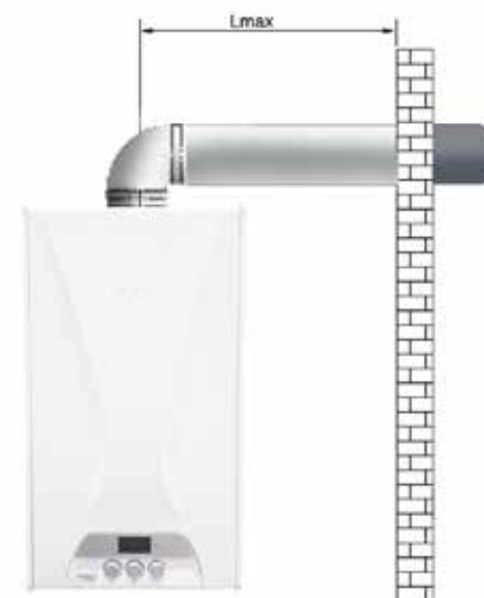
Горизонтальные герметичные дымовые трубы (Lmax с одним коленом: 4 м, 60/100) (Lmax с одним коленом: 6 м, 80/125)
