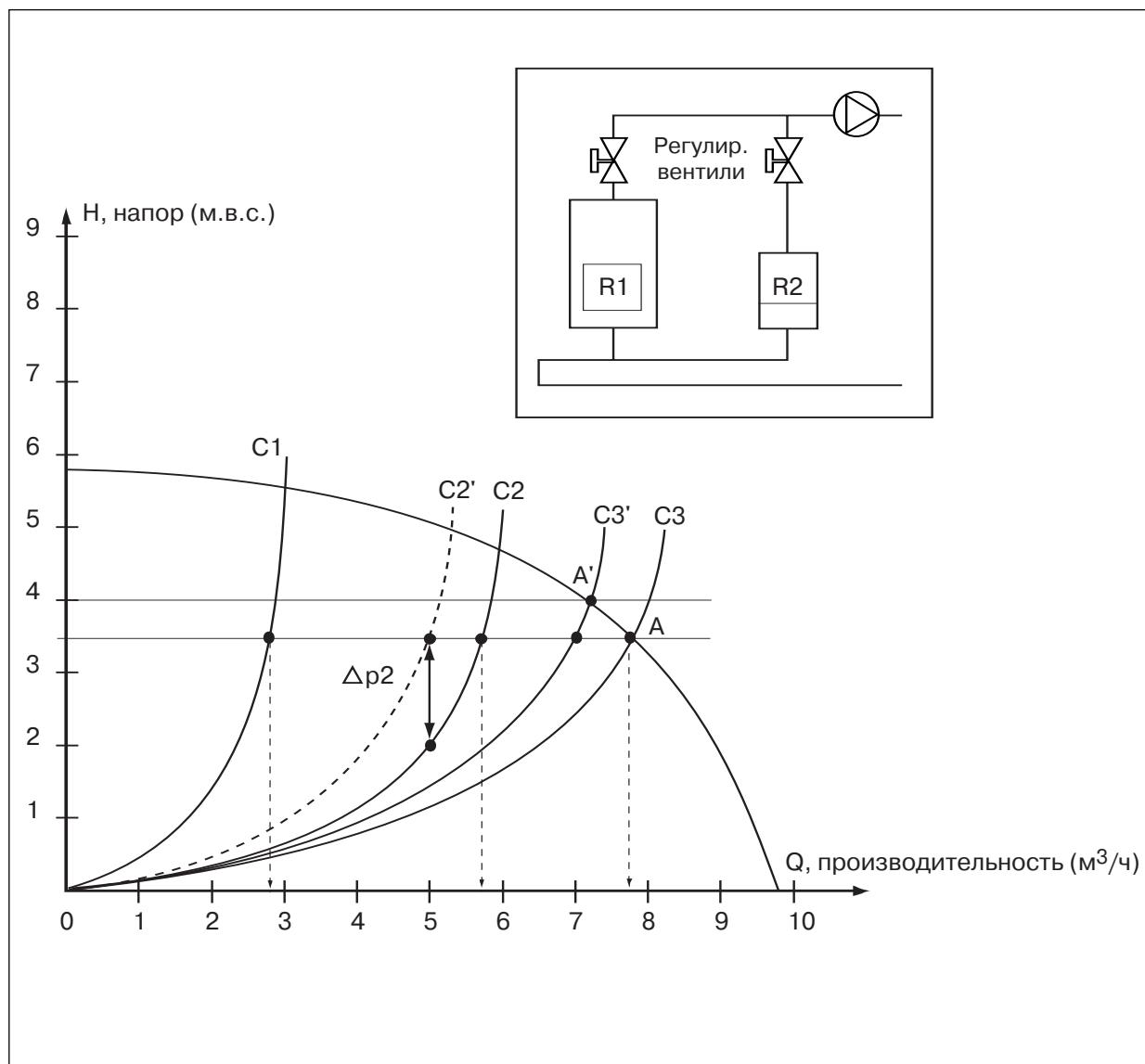
Выбирают такой насос, рабочая точка которого имела бы производительность СН1 + СН2 и для требуемого Δр - производительность СН1.
