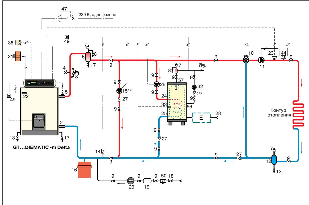
Насос (позиция 15) обеспечивает требуемый минимальный проток через котел.
