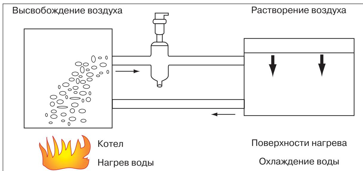
При нагревании воды в котле ее поглощающая способность уменьшается, и будет наблюдаться противоположный эффект: воздух отделяется и переходит в газообразное состояние. Согласно правила №2 предусмотрен воздухоотводчик на выходе из котла.
