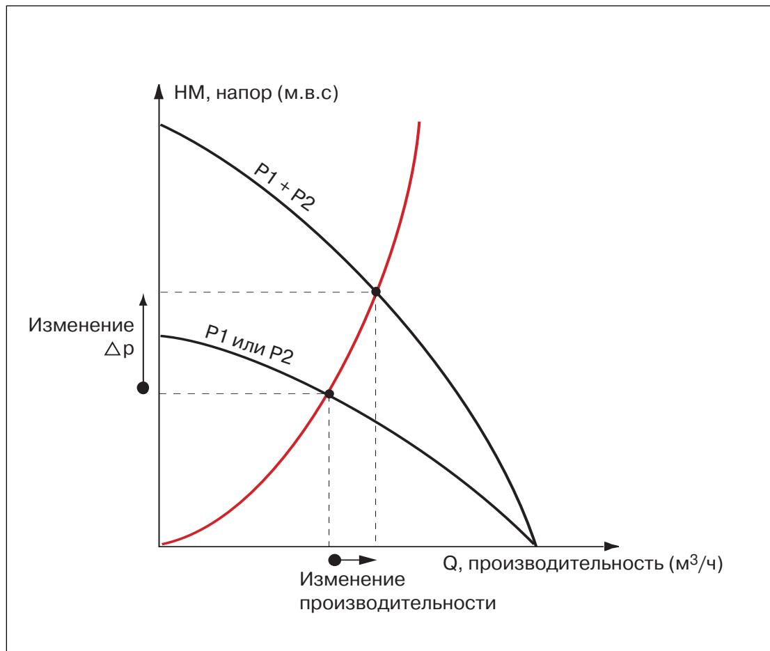
Обычно, последовательное включение насосов имеет относительно слабое воздействие на проток в системе.
