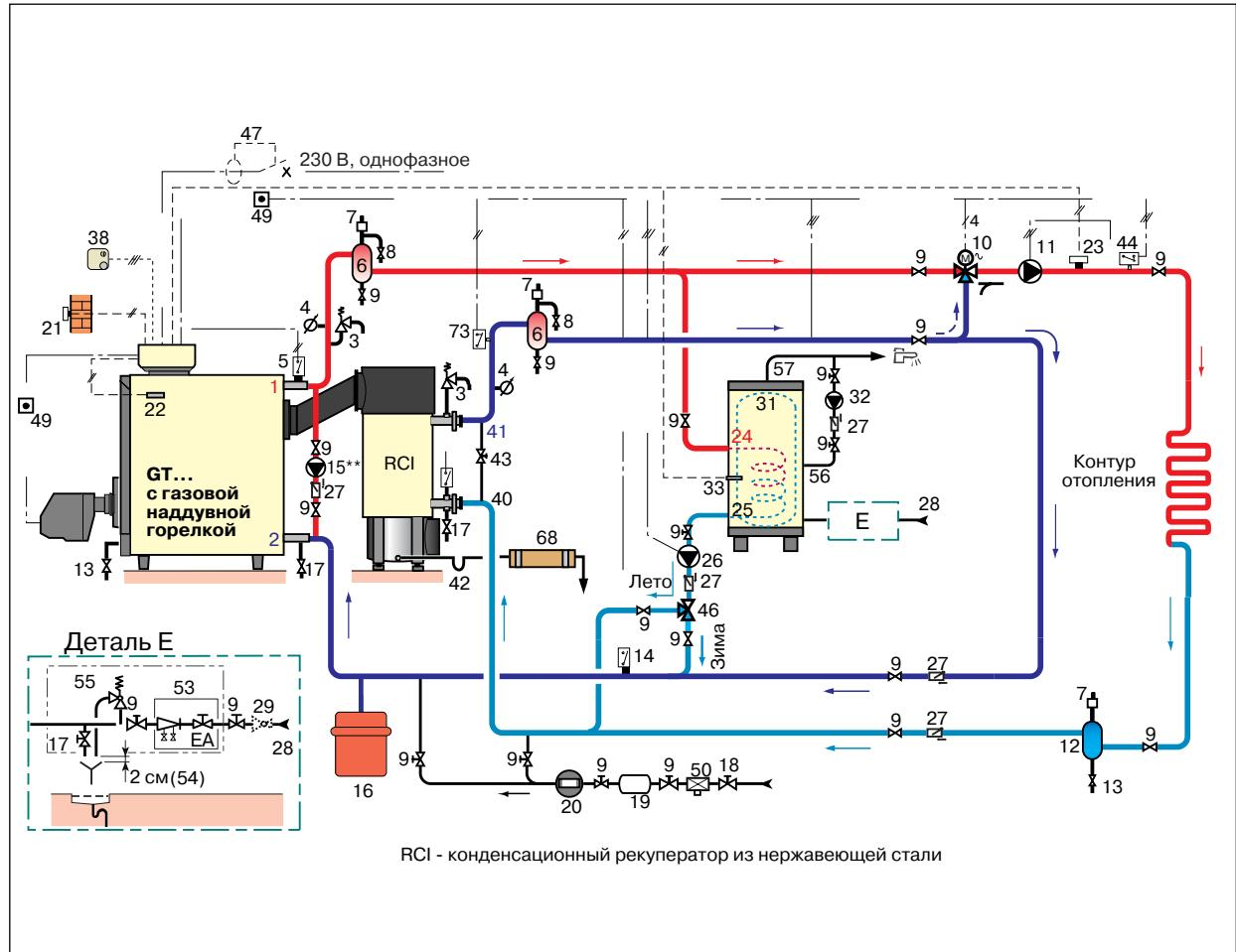
➤ Установка для отопления (1 контур) и горячего водоснабжения с термогидравлическим распределителем
