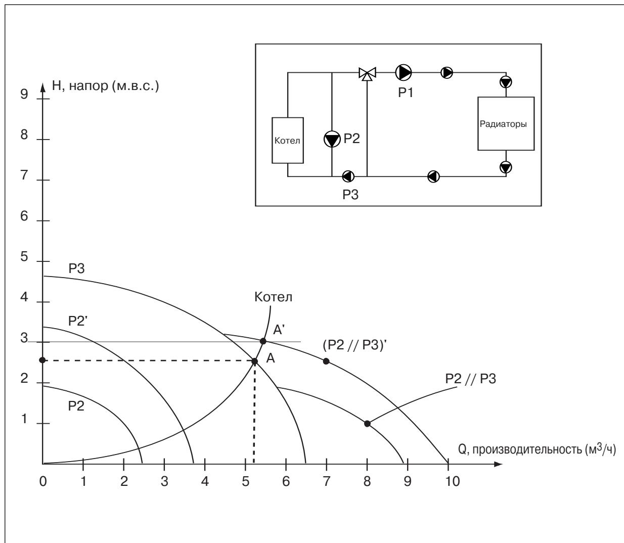
Чтобы избежать этой ситуации, нужно выбирать более мощный байпасный насос (на рисунке - Р2'), кроме того, насос Р2' будет вырабатывать такую же производительность при открытом трехходовом смесительном вентиле.
