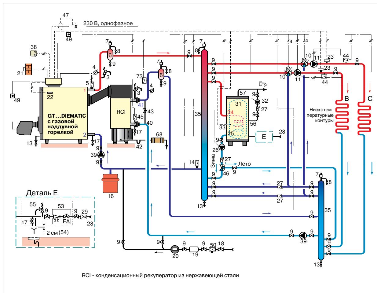
**Примечание:** циркуляционный насос (позиция 39) конденсационного рекуператора должен одновременно работать с циркуляционными насосами каждого из контуров отопления (позиция 11), подпиточным насосом (позиция 26) и питательным насосом котла (позиция 39).
