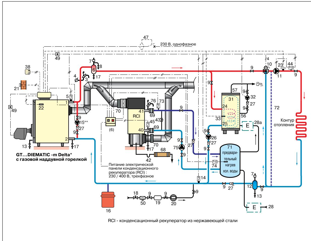
**Примечание:** качество нержавеющей стали конденсационного рекуператора (RCI) позволяет непосредственное подключить его к контуру воды бака-аккумулятора для предварительного нагрева горячей сантехнической воды (предварительный нагрев в качестве снабжения конденсационного рекуператора водой).
