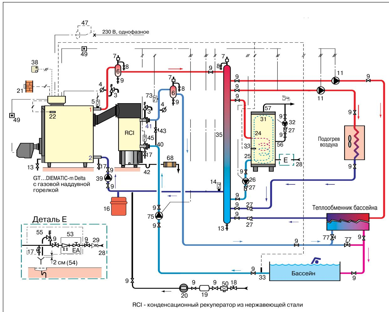
Заданное значение температуры на входе в бассейн (датчик температуры горячей воды - позиция 33) порядка 26°C контролируется панелью управления DIEMATIC-m Delta.
