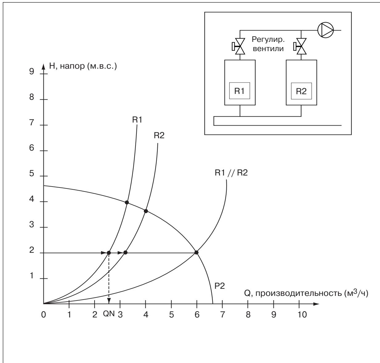
В этой системе от каждого котла вода поступает не с номинальным протоком. Вода ищет наиболее легкий путь. Это - котел с самой малой потерей напора ( $R_2$ ), от которого поступает больше воды в ущерб другому ( $R_1$ ).
