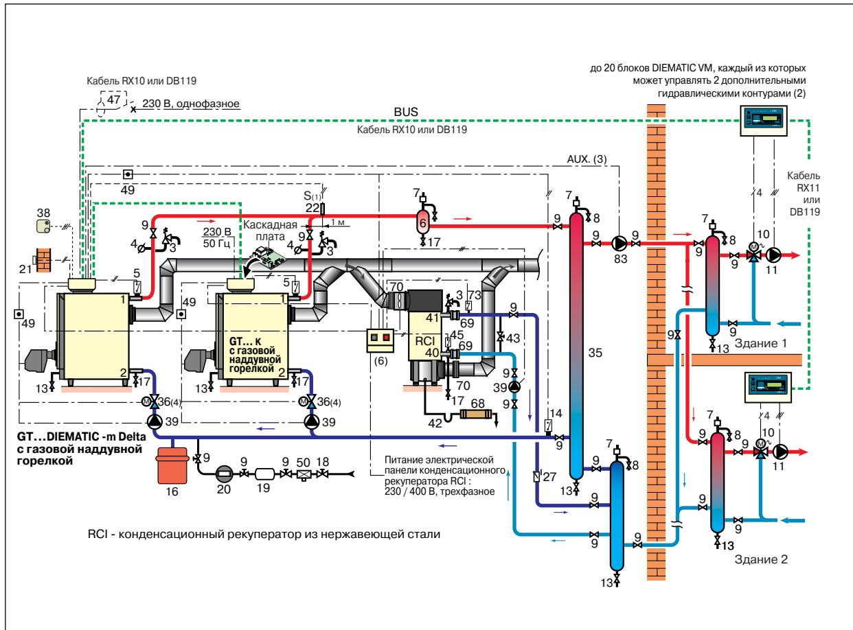
➤ Котельная установка бассейна (отопление помещений, горячее водоснабжение и бассейн) с конденсационным рекуператором из нержавеющей стали (RCI), предназначенного для предварительного нагрева бассейна:
