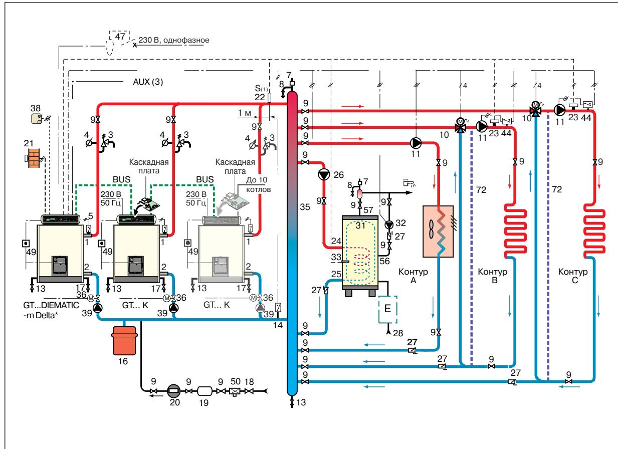
Для данной конфигурации контуров запорные вентили с сервоприводом (позиция 36) можно заменить на обратные клапаны.
