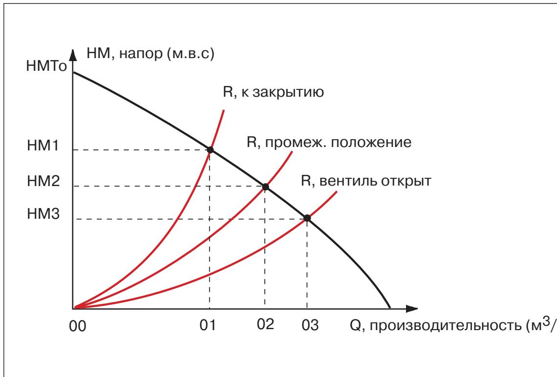
Когда вентиль закрыт, проток через него равен нулю и гидростатическая высота максимальна.
