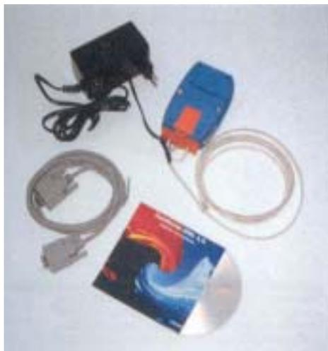
Программатор предназначен для просмотра, тестирования и перепрограммирования платы управления Dancon кондиционеров Danline и Escalade. Данные операции выполняются с помощью компьютера, подключаемого к разьему RS485 кондиционера через интерфейсный блок.
