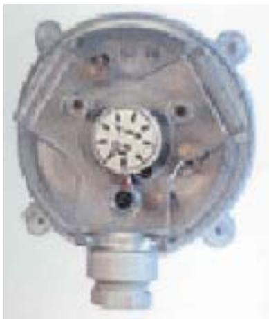
Данная опция настоятельно рекомендуется при использовании фильтра тонкой очистки, но также весьма полезна при использовании стандартного фильтра G4. Датчик замеряет давление воздушного потока на входе и выходе фильтра. Если разница давлений превышает заданное значение, на панели управления загорается индикатор, сигнализирующий о необходимости замены фильтра.
