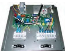
Опция является управляющим элементом канальных или напольно-потолочных фанкойлов. Плату управления используется при необходимом подключении фанкойла к системе группового управления, либо при управлении с помощью ИК пульта
