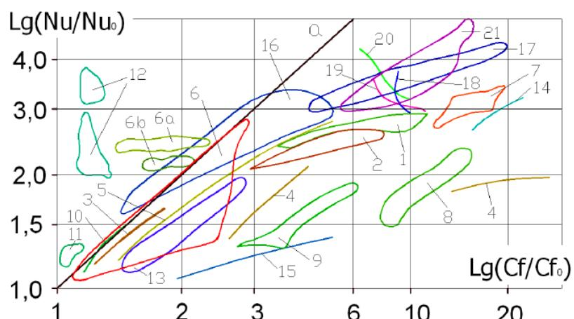
Особый интерес представляют следующие области, находящиеся на и над кривой аналогии Рейнольдса 6, ба, бб – сферические углубления различной формы, (однофазный теплоноситель), 12 – сферические углубления (двухфазный теплоноситель); а: линия аналогии Рейнольдса.
