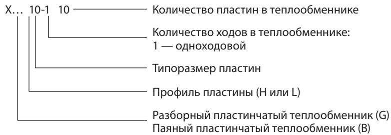
Пример условного обозначения двухходового теплообменника
