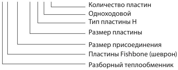
Пример условного обозначения разборных пластинчатых теплообменников серии XGM
